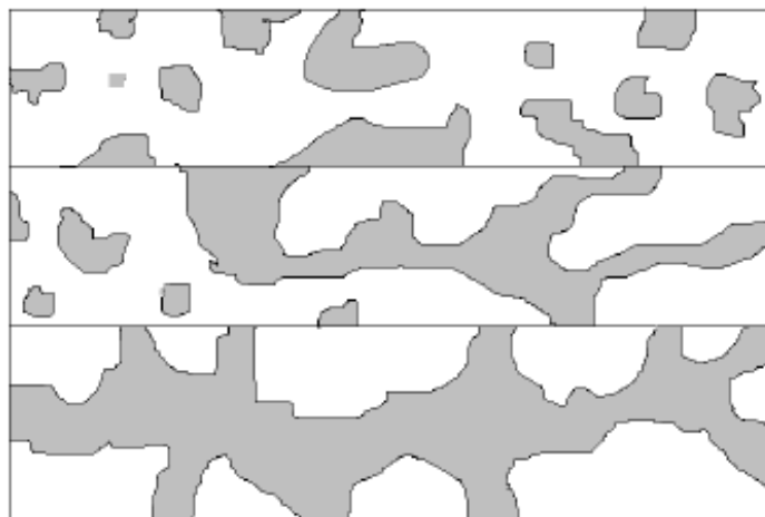
Figura 1.9: Formação da rede condutora durante a transição isolante-condutor numa matriz anisotrópica.[62]
