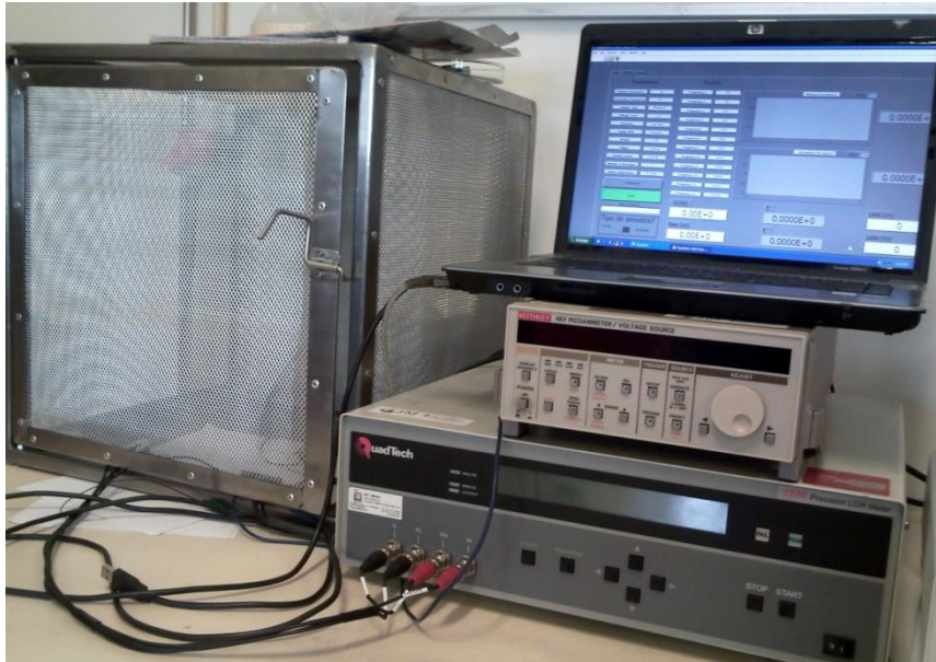
Figura 2.3: Disposição dos equipamentos utilizados nos ensaios de espectroscopia dielétrica e de resistividade volúmica. À esquerda, a gaiola de Faraday.
