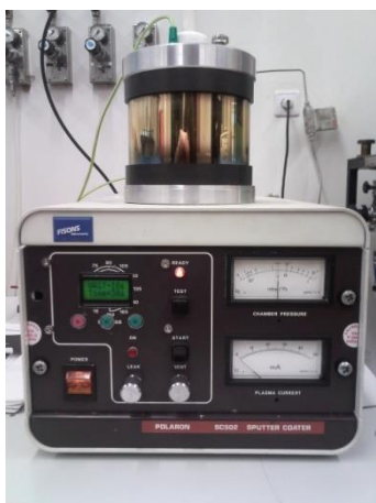
Figura 2.1: Sputter coater utilizado na deposição dos elétrodos.
