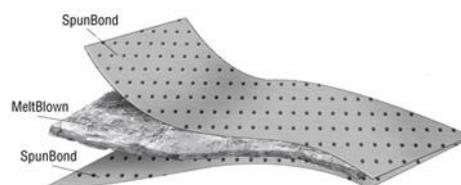
Figura 10 – Representação de um material SMS (*Polysafe.com*, 2014)
