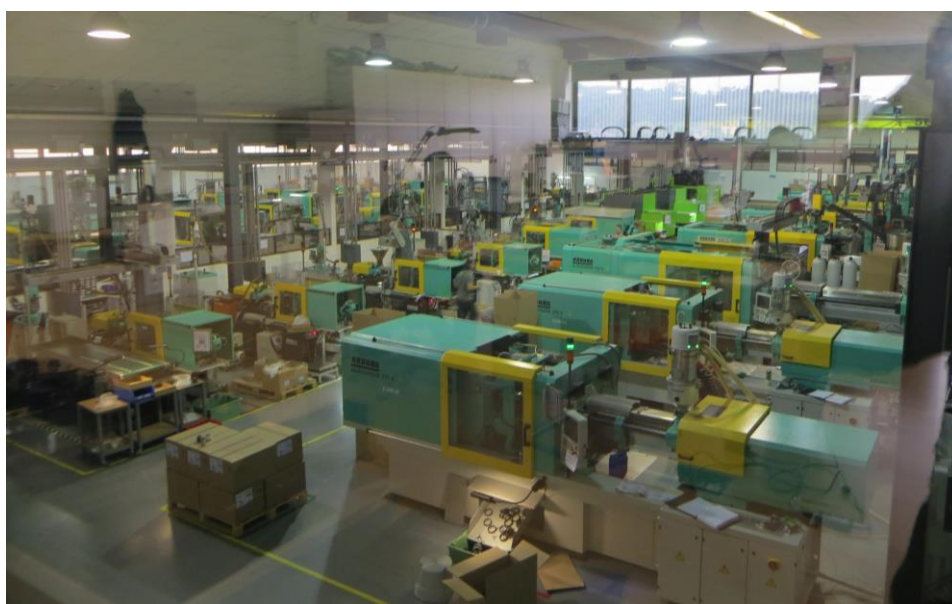
Figura 14 - Secção de Injeção
