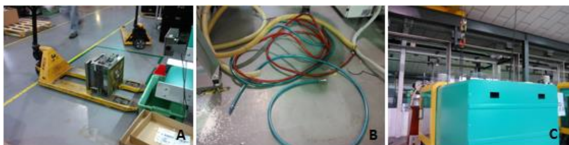
Figura 66 - Implementação SMED: (A) preparação de molde; (B) mangueiras; (C) posicionamento de grua
