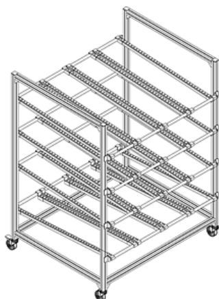
Figura 68 - Estante para colocação de materiais de embalagem e produto acabado nos PTs (retirado de “Europneumaq Lda”)
