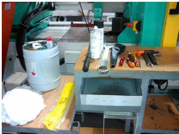
Figura 67 - Carrinho de ferramentas para mudança de molde, com o auxílio de check-list
