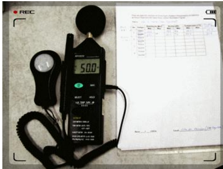
Figura 4.6 – Equipamento de Medição dos Parâmetros Físicos do Ambiente Térmico (foto do autor).
