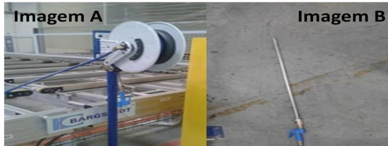
Figura 54: Desenrolador de ar comprimido e ponteira para mangueira
