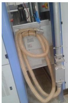
Figura 52: Colocação de tubos de aspiração conectáveis ao sistema de aspiração
