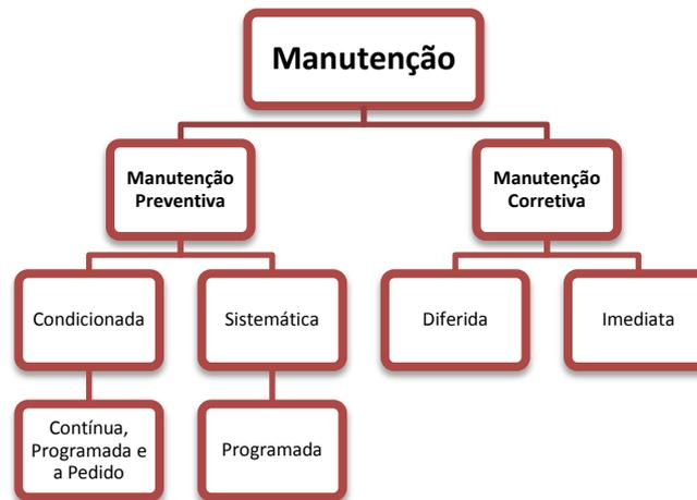
Figura 3: Classificação dos tipos de intervenções de manutenção segundo a norma EN 13306 (2007)
