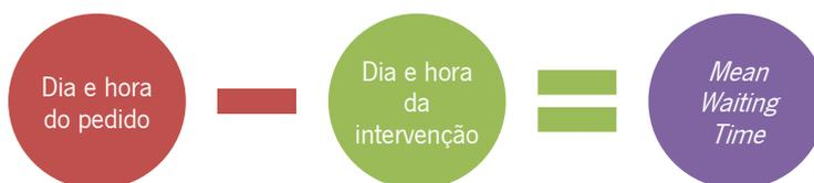
Figura 95. Determinação do *Mean Waiting Time* (MWT)
