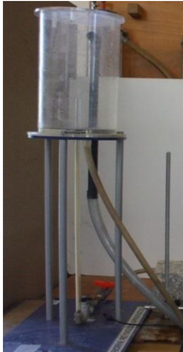
Figura 3.5 – Reservatório de nível constante
