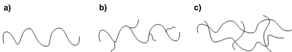
Figura 2.4 – Representação da estrutura molecular: (a) linear, (b) ramificada e (c) reticulada (adaptado de Bower (2004))
