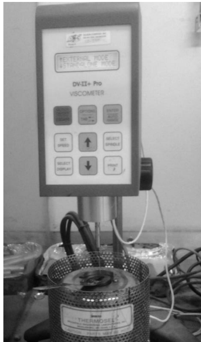
Figura 3.8 – Ensaio de Viscosidade Dinâmica
