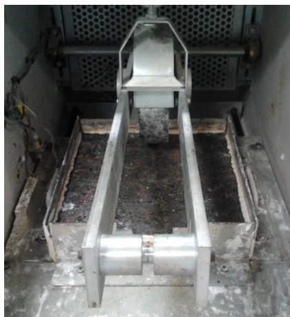
Figura 3.18 – Ensaio de Deformação Permanente
