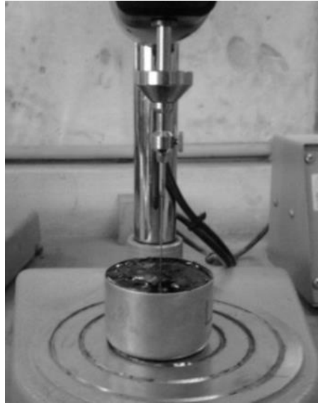
Figura 3.4 – Ensaio de Penetração a 25 °C com agulha
