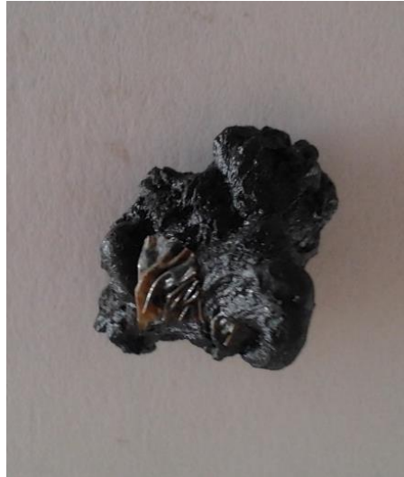
Figura 4.12 – Consistência do topo do ligante BO10E5 após o ensaio de estabilidade ao armazenamento
