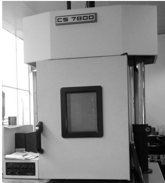
Figura 3.17 – Equipamento do Ensaio de Determinação de Módulo e Ensaio de Fadiga por flexão em quatro pontos
