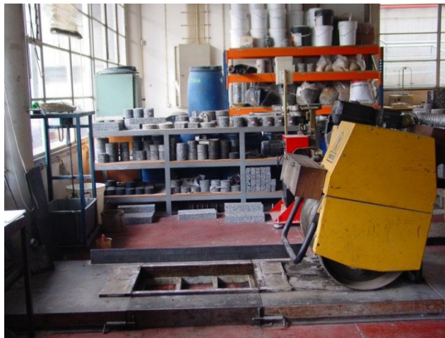
Figura 3.6 – Molde e cilindro de rolos de rasto liso
