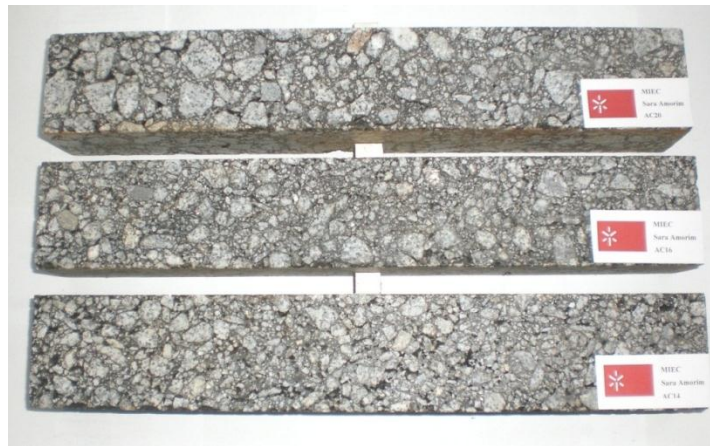
Figura 3.8 – Provetes das três misturas: AC14, AC16 e AC20
