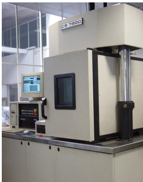
Figura 3.10 – Equipamento servo-hidráulico para realização dos ensaios de módulo de rigidez
