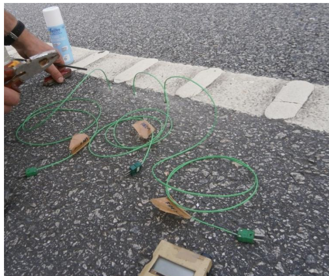
Figura 3.14 – Instrumentos para medição da temperatura do pavimento
