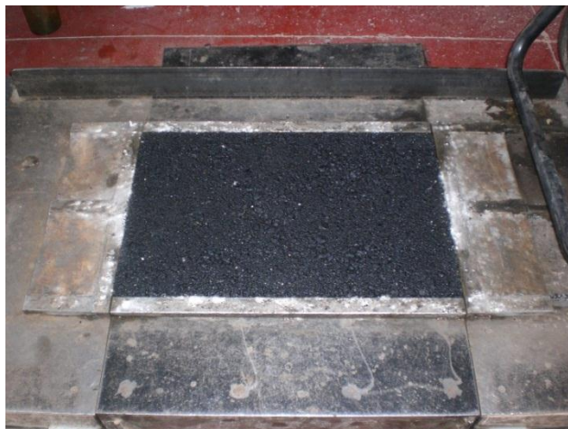
Figura 3.7 – Mistura no molde depois da compactação
