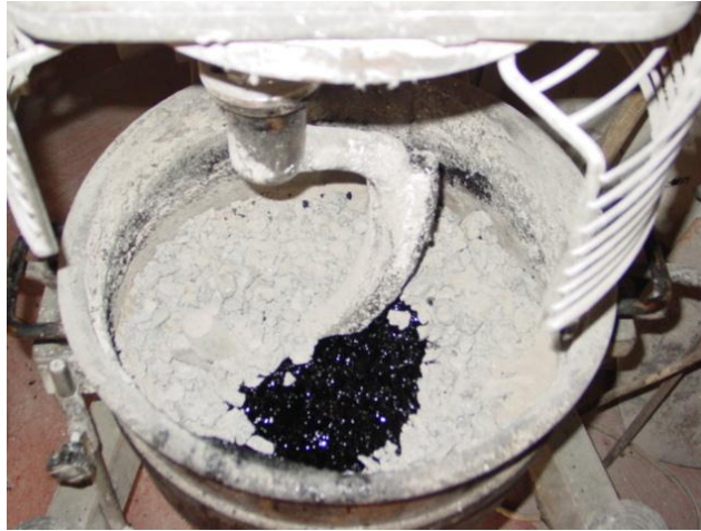
Figura 3.4 – Introdução do betume na mistura de agregados
