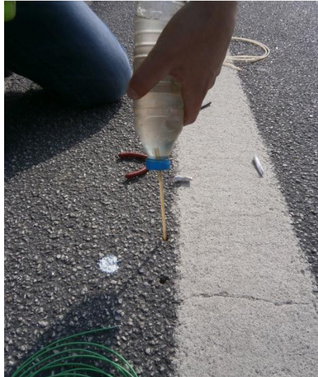
Figura 3.13 – Introdução da glicerina para medição da temperatura do pavimento
