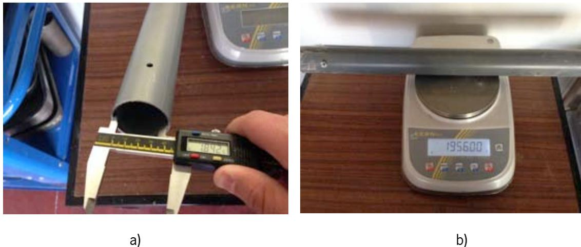
Figura 60 - Verificação da densidade desejada: a) controle de volume do molde; b) verificação da densidade desejada
