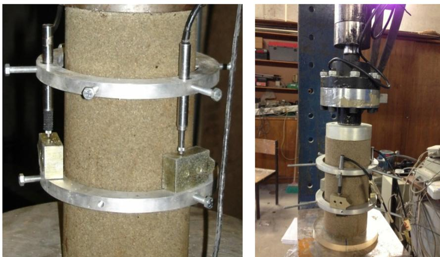
Figura 45 - Fixação de anéis e colocação dos LVDT's
