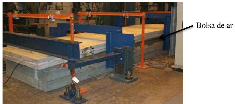
Figura 2.17: Aplicação de carga uniformemente distribuída (Pissiki e Mlynarczyk, 2013)
