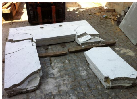
Figura 5.49: Rotura do Painel 5, após ensaio
