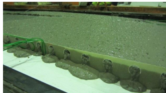
Figura 4.9: Passagem de betão com fibras pelos furos do conector
