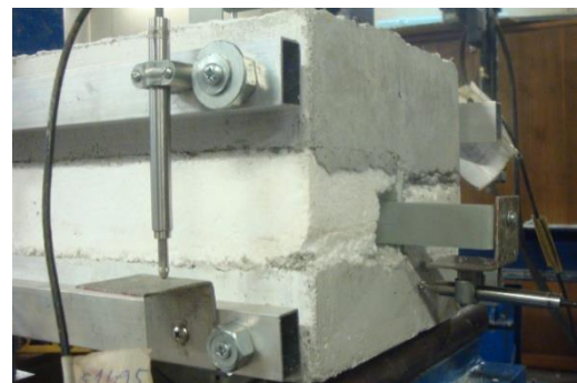
Figura 3.14: Fixação dos transdutores nos topos das vigas sandwich
