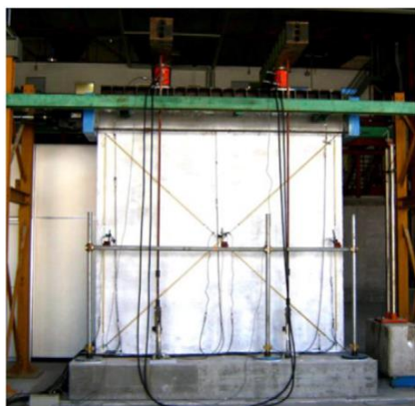
Figura 2.20: Painel em consola (Pavesa e Bournas, 2011)
