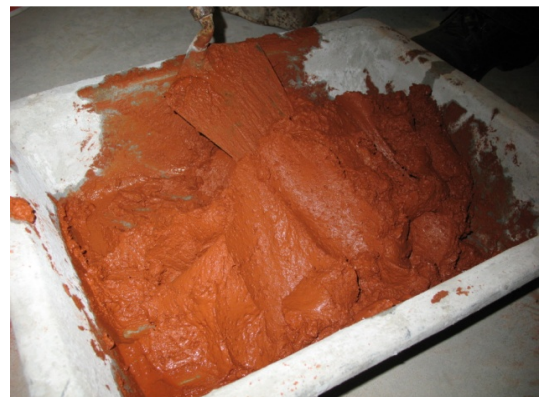
Figura 5.7 – Preparação em laboratório da argamassa de terra.
