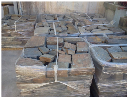
Figura 5.21 – Xisto utilizado na construção das paredes de alvenaria.
