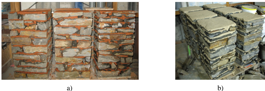
Figura 5.14 – Prismas de alvenaria de xisto: a) Prismas com argamassa de terra; b) Prismas com argamassa artificial.
