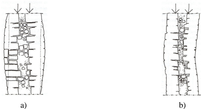
Figura 3.44 – Flexão de paredes com dois paramentos: a) afastamento dos paramentos exteriores; b) flexão de ambos os paramentos na mesma direção (Tubi, 2006).
