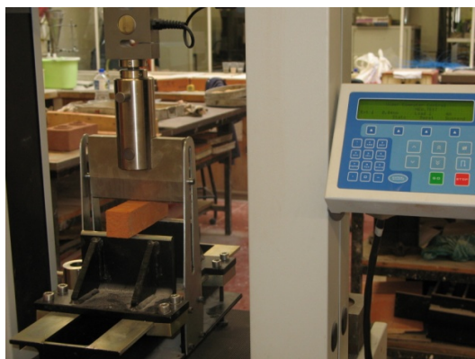
Figura 5.8 – Ensaio de resistência mecânica à flexão das amostras de argamassa de terra.
