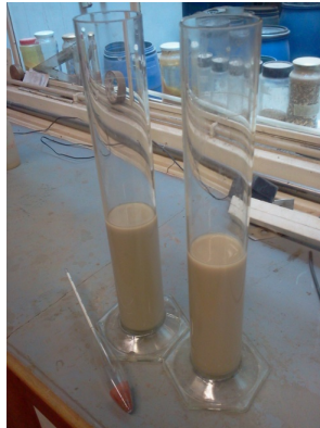
Figura 5.10 – Soluções e densímetro na execução do ensaio de Bouyoucos.
