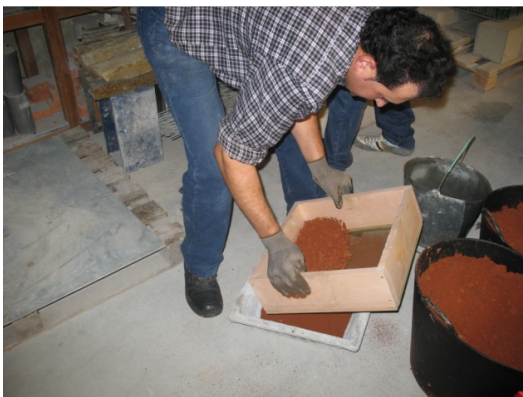
Figura 5.7 – Preparação em laboratório da argamassa de terra.
