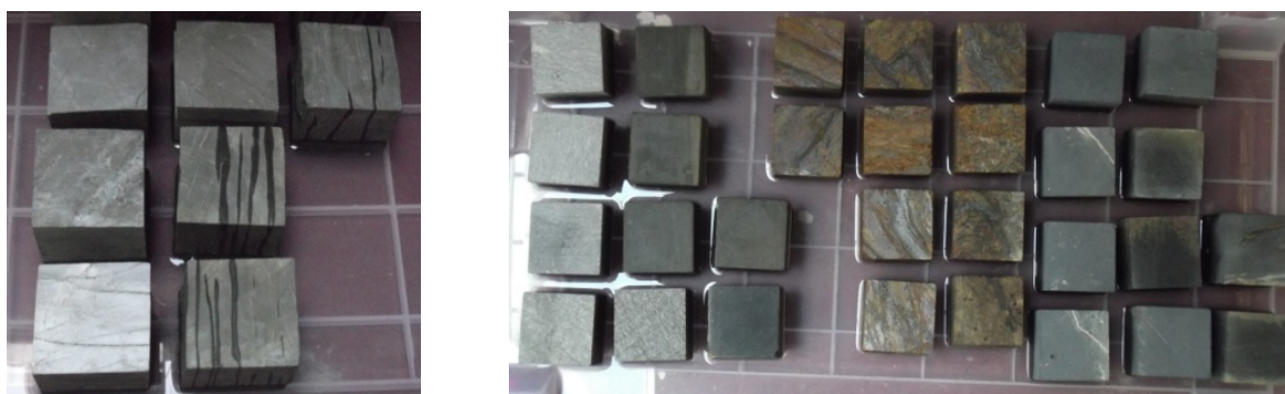
Figura 4.8 – Ensaio de absorção de água por capilaridade.
