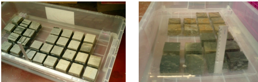
Figura 4.6 – Ensaio de absorção de água à pressão atmosférica.
