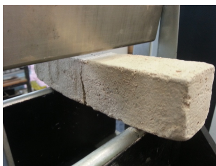
Figura 5.12 – Ensaio de resistência mecânica à flexão da argamassa de terra artificial.
