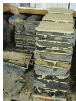
Figura 5.13 – Preparação de prismas de xisto: a) Prismas com argamassa de terra; b) Prismas com argamassa artificial.
