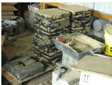
Figura 5.13 – Preparação de prismas de xisto: a) Prismas com argamassa de terra; b) Prismas com argamassa artificial.
