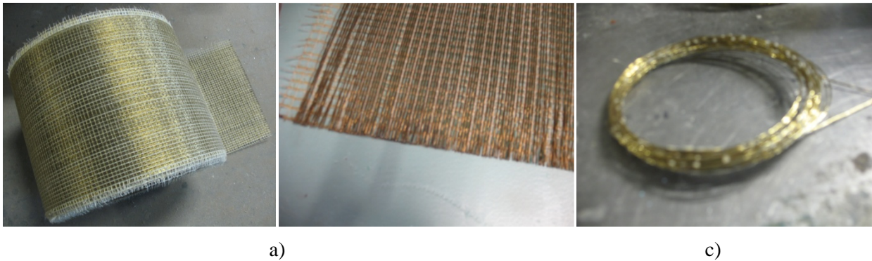
Figura 5.33 – Fibras de aço da Hardwire: a) Fibras de aço usadas; b) Cordão metálico extraído.
