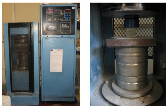
Figura 4.14 – Ensaio de resistência à compressão uniaxial.
