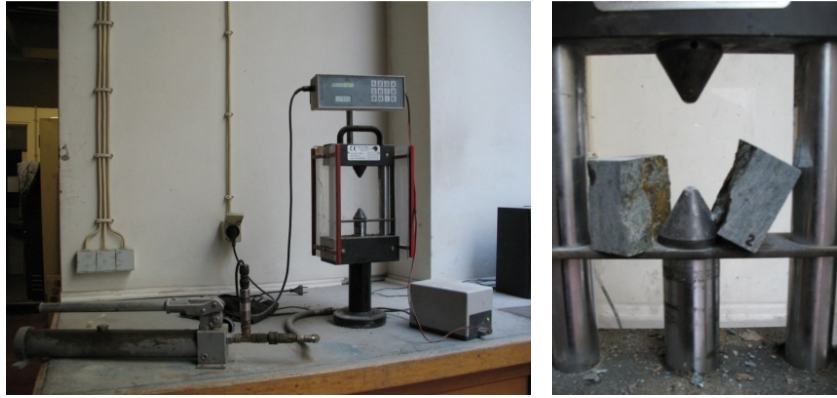
Figura 4.16 – Ensaio de carga pontual.
