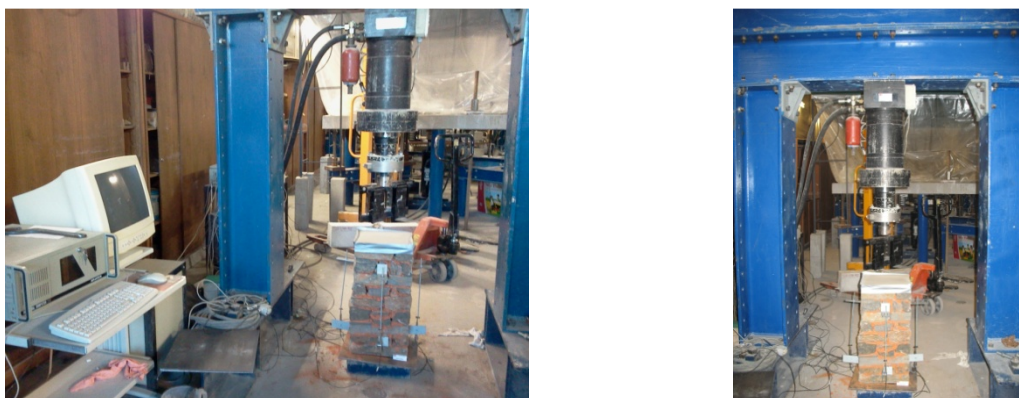
Figura 5.15 – Esquema de ensaio adotado no ensaio de compressão axial dos prismas.
