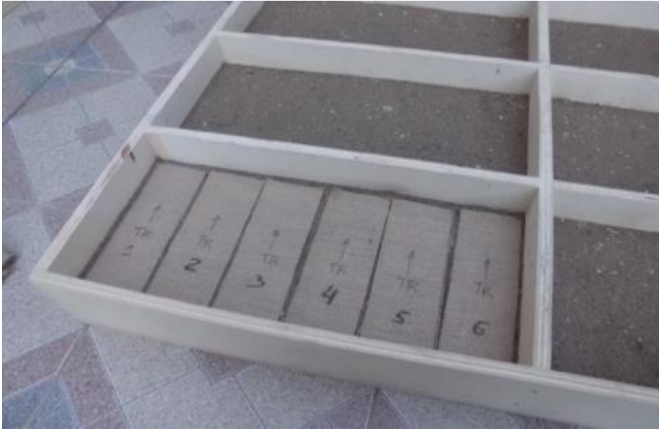
Figura 15 – Colocação das amostras de fibras no solo.
