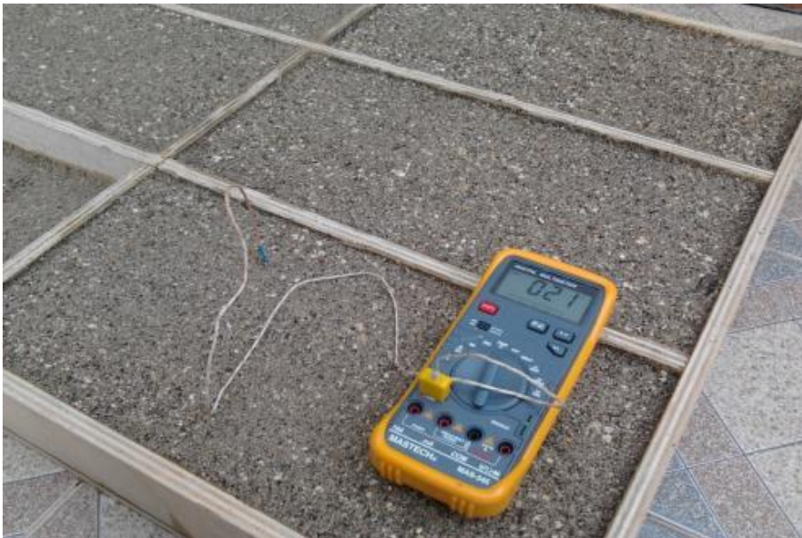
Figura 26 – Determinação da temperatura do solo através de um termopar.
