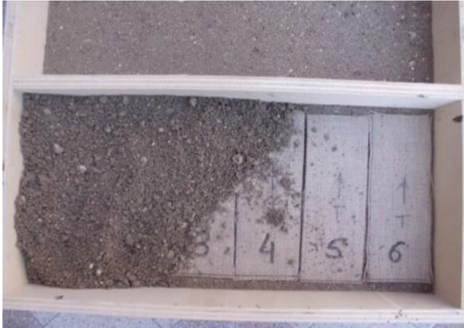
Figura 17 – Colocação da segunda camada de solo.
