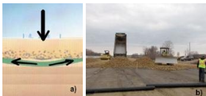
Figura 7 – Função de reforço dos geotêxteis.
