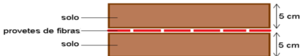
Figura 12 – Representação esquemática do solo incorporando as fibras.
