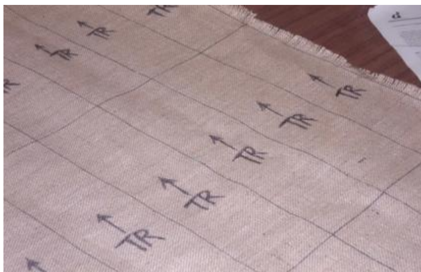
Figura 13 – Processo de corte dos provetes de fibra de juta.
