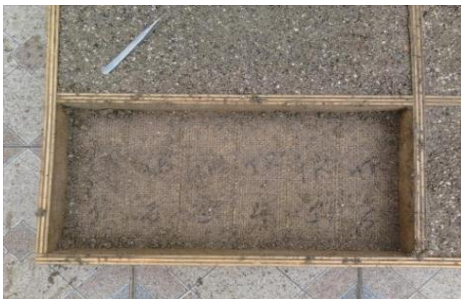
Figura 22 – Remoção dos provetes de sisal do solo.
