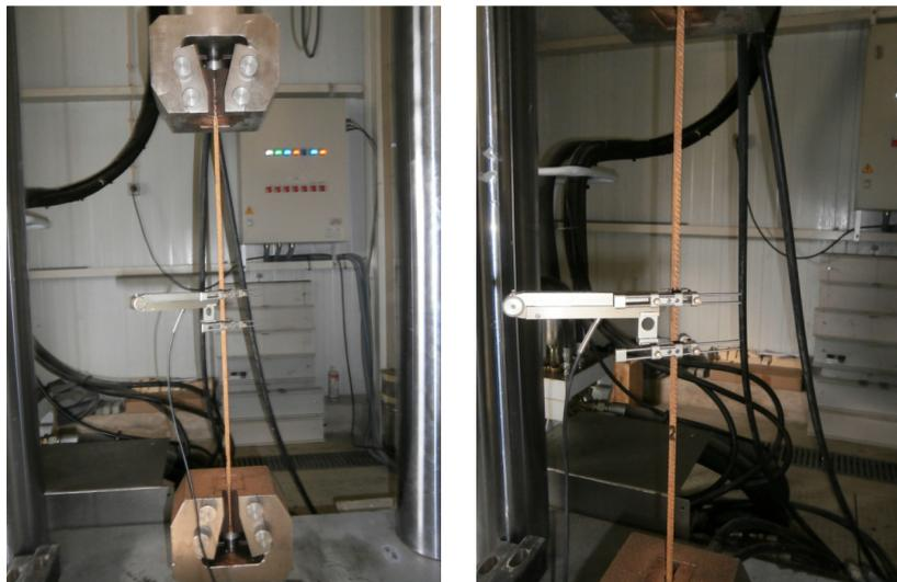
Figura 3.9 - Preparação do ensaio de tração para os varões de aço e pormenor do clip-gauge.
