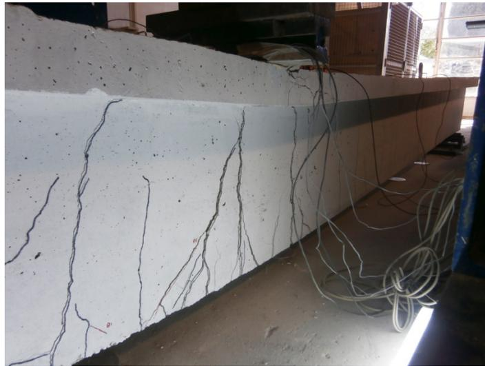
Figura 3.18 – Modo de rotura da Viga\_1.
