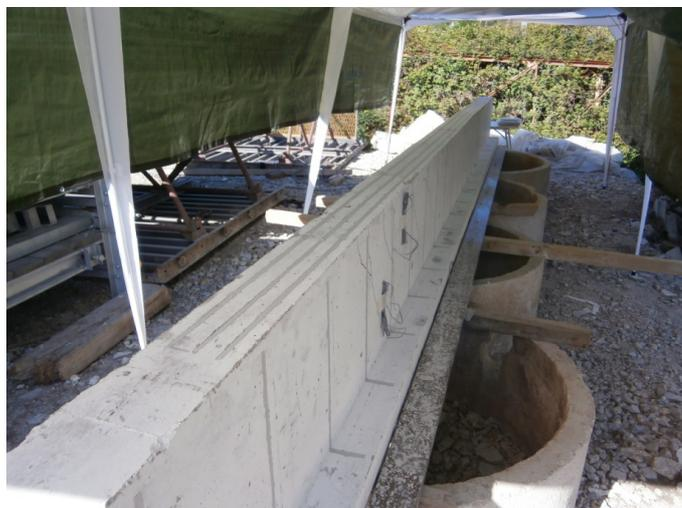
Figura 3.25 - Aspeto geral da viga após a aplicação do reforço de CFRP.
