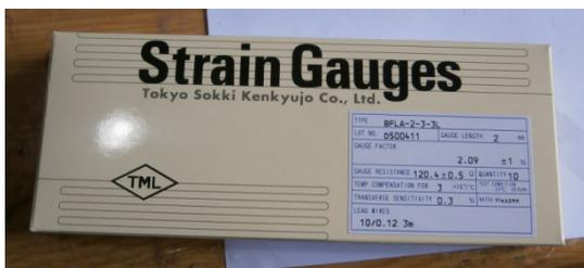
c) Tipo de extensómetro usado.
