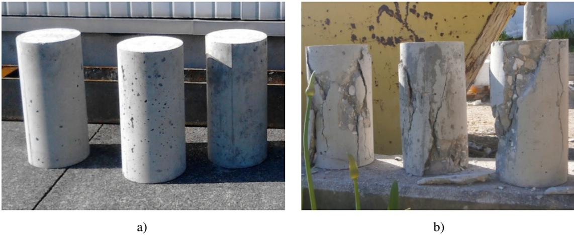
Figura 3.5 - a) Provetes cilíndricos; b) modo de rotura obtido em três provetes representativos.
