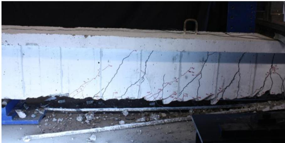
Figura 3.33 – Modo de rotura da Viga\_2.
