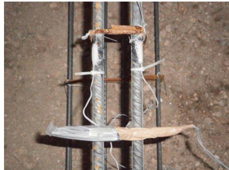
b) Extensômetros colados nos varões longitudinais.
