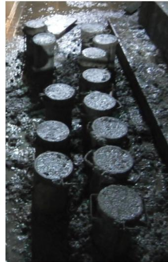
f) Betonagem dos provetes cilíndricos.
