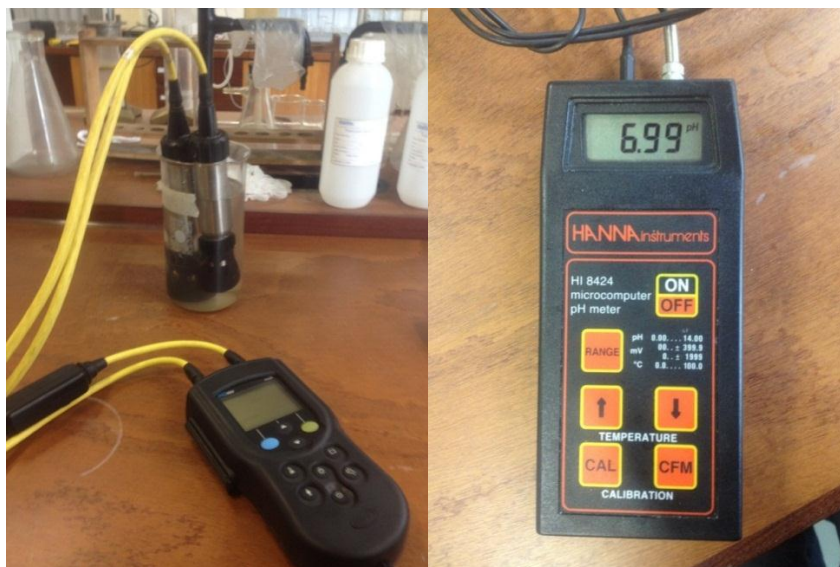
Figura 4.4 - Leitura da Condutividade e OD e % OD (Esq.) e leitura de pH e temperatura (Dir.)
