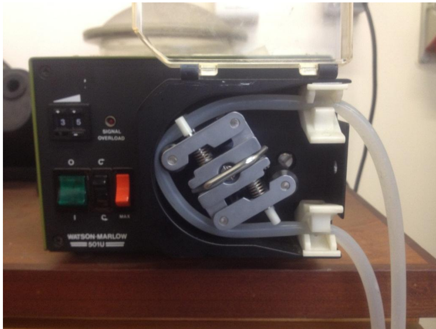
Figura 4.6 - Bomba utilizada no processo da retro lavagem
