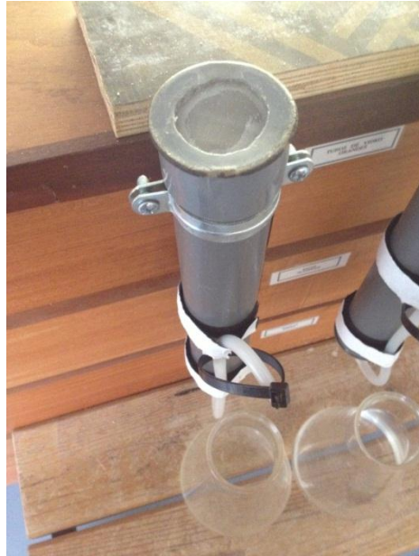
Figura 4.7 - Filtro de areia com tampa de retenção de finos
