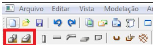
Figura 32 – Ícones referentes à criação de sapatas (*software* Tekla Structures)
