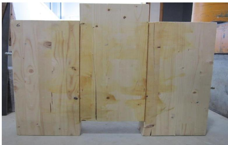
Figura 4.6 – Proвете com cola após ensaio de corte simples
