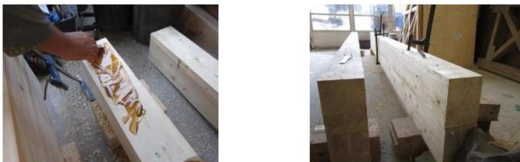
Figura 3.8 – Aplicação da cola MAPEWOOG Gel 120 e da pressão durante a cura
