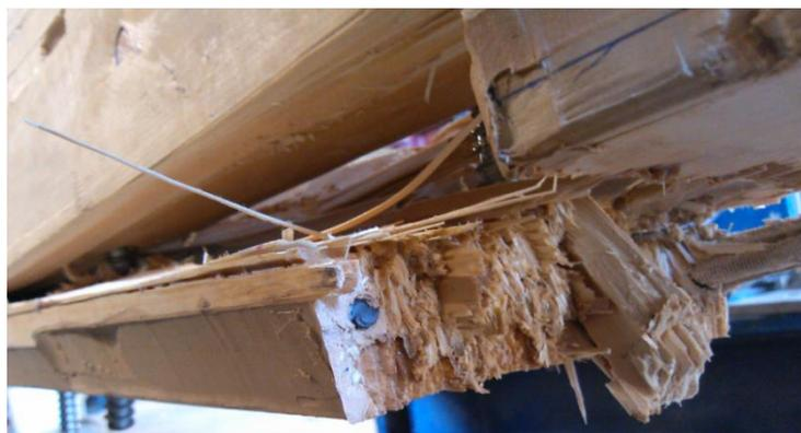
Figura 3.16 – Rotura dos varões longitudinais
