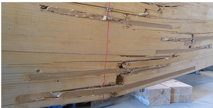
Figura 3.15 – Deslizamento dos varões longitudinais
