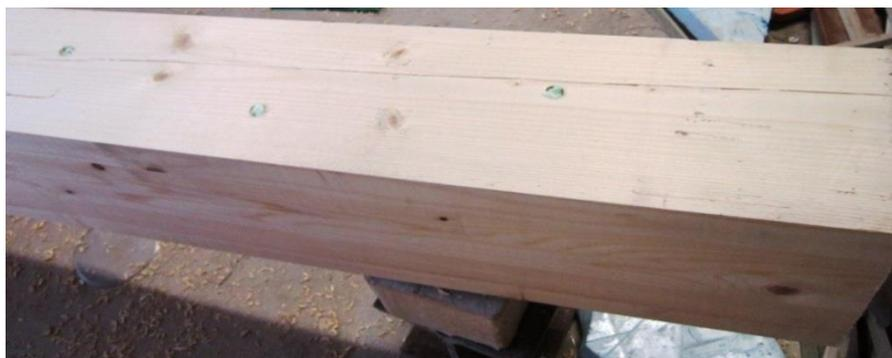
Figura 3.7 – Selagem dos pré-furos com espuma
