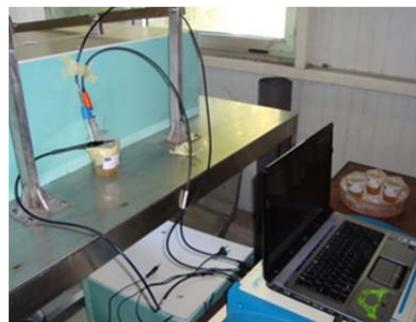
Figura 5.8 - Potencióstato controlado pelo software VoltaMaster-4
