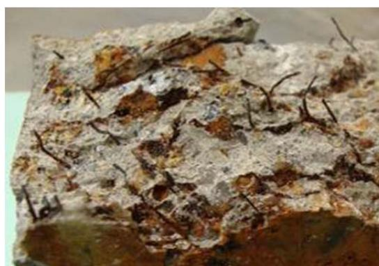
Figura 4.51 - Secção de fratura dos provetes de BACRFA
