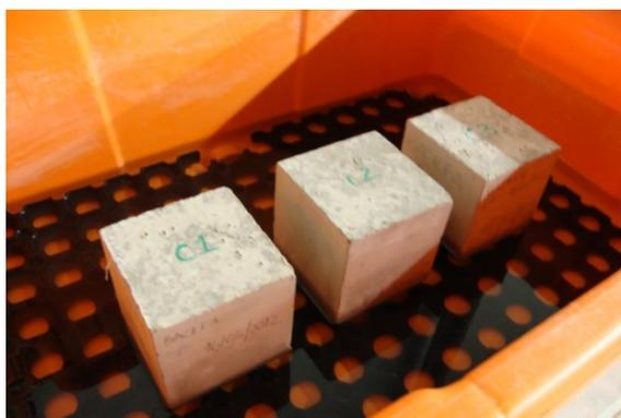
Figura 4.28 - Recipiente onde se realizaram os ensaios de absorção de água por capilaridade
