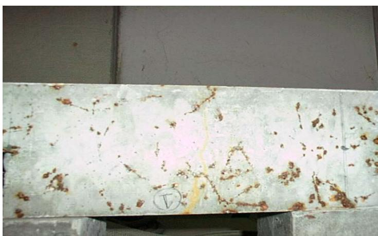
Figura 2.5 - Corrosão superficial em BRFA (Balouch *et al.*, 2010)
