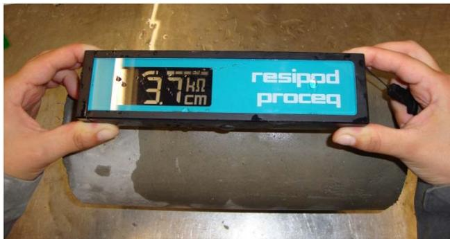
Figura 4.39 - Esquema de leitura da resistividade elétrica nos provetes cilíndricos
