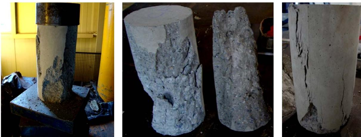
Figura 4.13 - Modos de rotura em compressão típicos dos provetes de BAC
