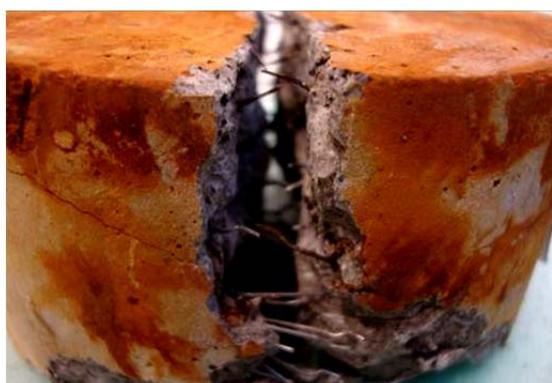
Figura 4.50 - Corrosão superficial dos provetes de BACRFA e corrosão das fibras de aço no comprimento de penetração dos cloretos
