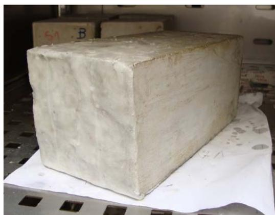
Figura 4.62 - Exposição da viga na câmara de carbonatação
