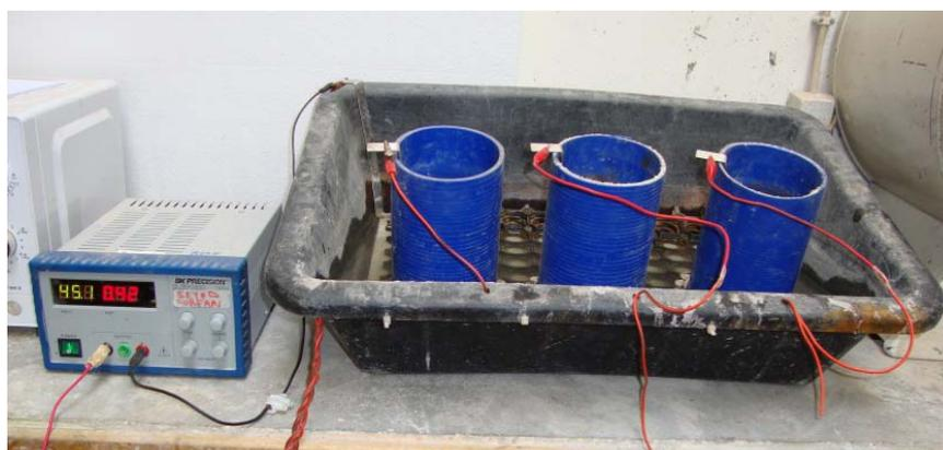
Figura 4.42 - Esquema do ensaio de difusão de cloretos (LNEC E463)
