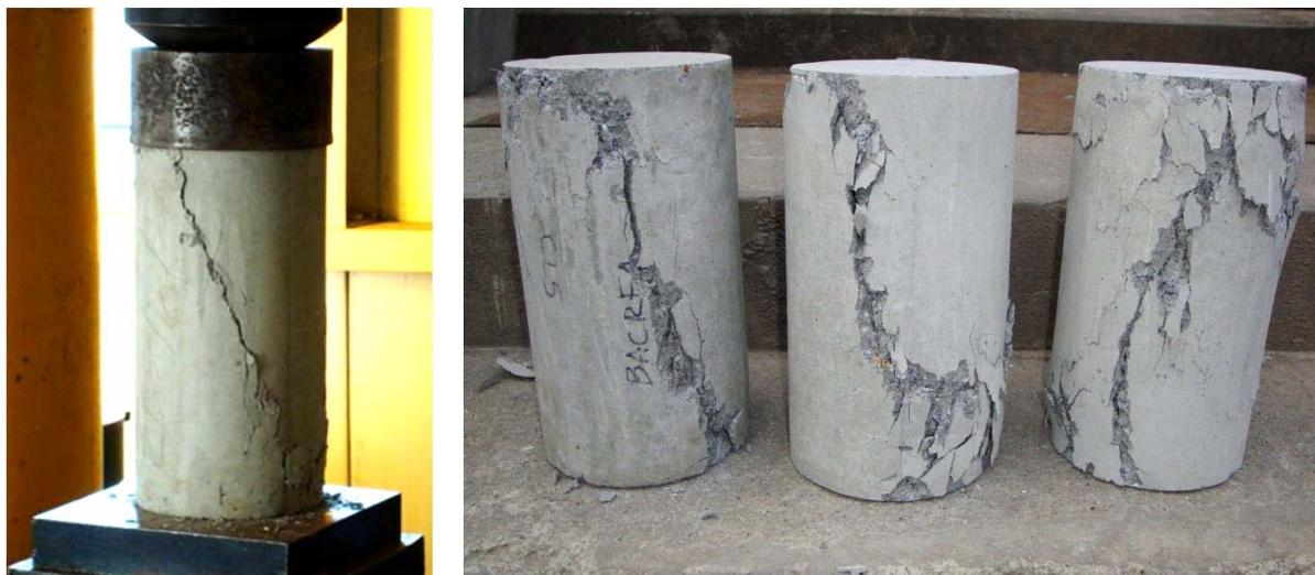
Figura 4.14 - Modos de rotura em compressão típicos dos provetes de BACRFA
