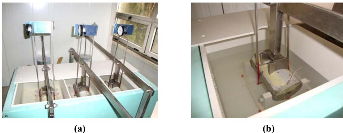
Figura 6.12 - Imersão dos provetes no Reservatório 1
