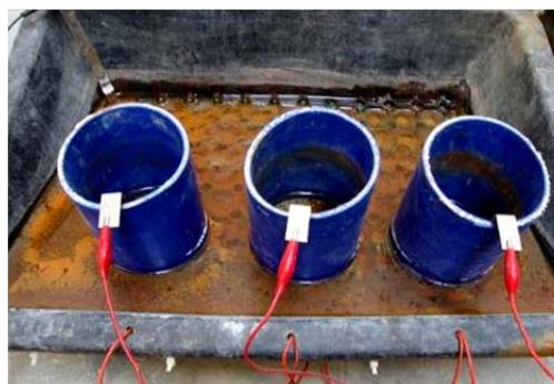
Figura 4.45 - Observação da formação de resíduos provenientes da corrosão das fibras de aço durante o ensaio com provetes de BACRFA
