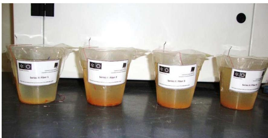
Figura 5.12 - Imersão das fibras de aço em solução de 3.5% NaCl durante 7 dias
