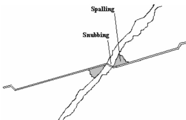
Figura 6.23 - Efeito de “*snubbing*” observado no arrancamento das fibras (Døssland, 2008).
