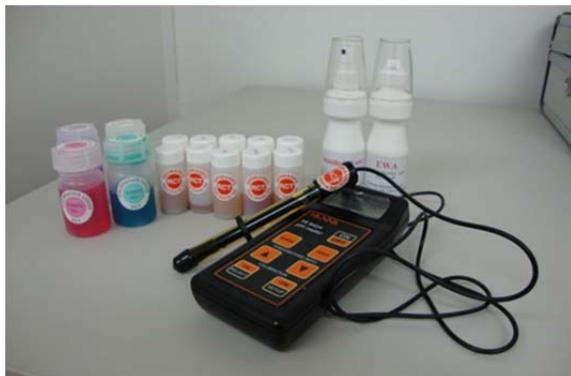
Figura 4.56 - *Kit RCT-500*: Calibradores de elétrodo, frascos com líquido de extração, agente líquido do elétrodo e o elétrodo.
