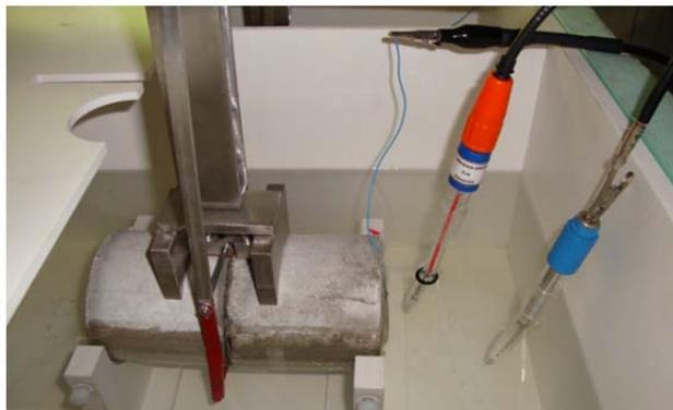
Figura 6.16 - Célula eletroquímica para realização do ensaio OCP
