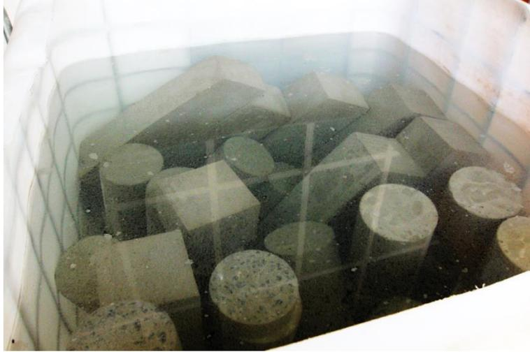
Figura 3.13 - Cura dos provetes em água à temperatura ambiente
