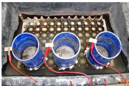
Figura 4.44 - Observação do aspeto límpido da solução catódica no ensaio com provetes de BAC
