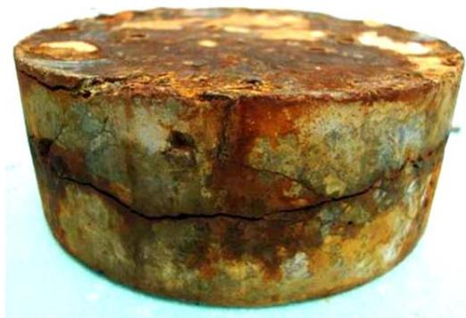
Figura 4.47 - Corrosão superficial e macro-fissuração observada nos provetes ensaiados (face superior exposta à solução anódica)
