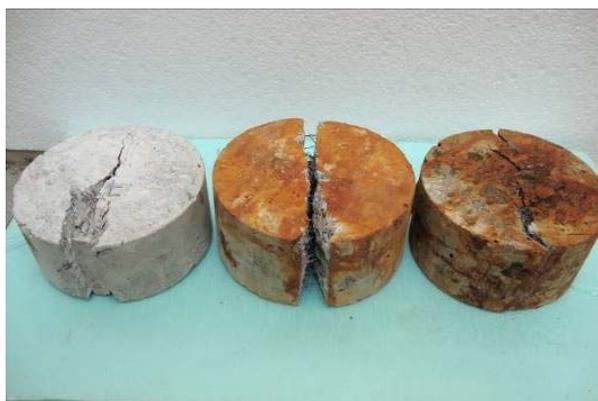
Figura 4.49 - Provete de BACRFA após ensaio de resistência à tração por compressão diametral, com e sem exposição à migração de cloretos
