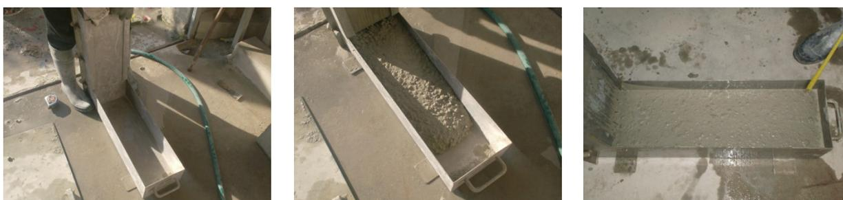
Figura 4.4 - Ensaio da caixa L
