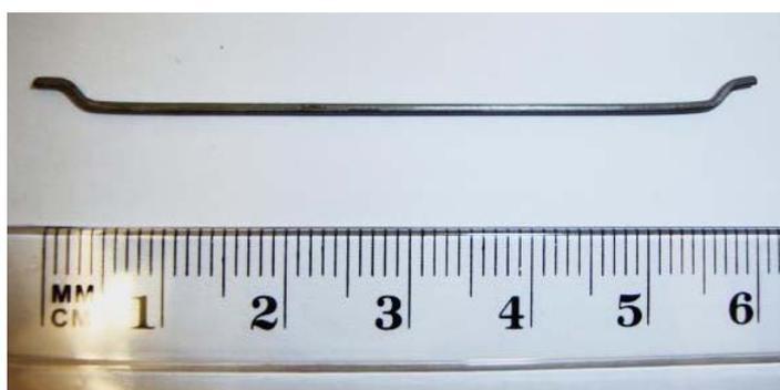
Figura 5.6 - Fibra de aço de extremidades dobradas
