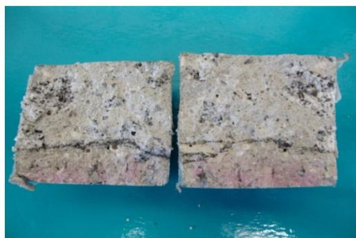
Figura 4.34 - Penetração da solução em provete de BAC
