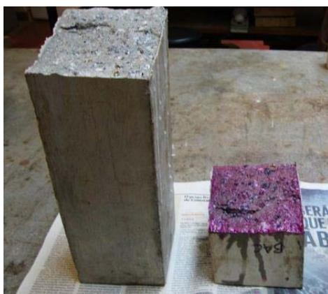
Figura 4.61 - “Fatia” partida da viga para análise da profundidade de carbonatação
