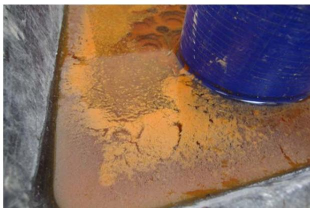
Figura 4.46 - Produtos de corrosão das fibras de aço visíveis no decorrer do ensaio de provetes de BACRFA
