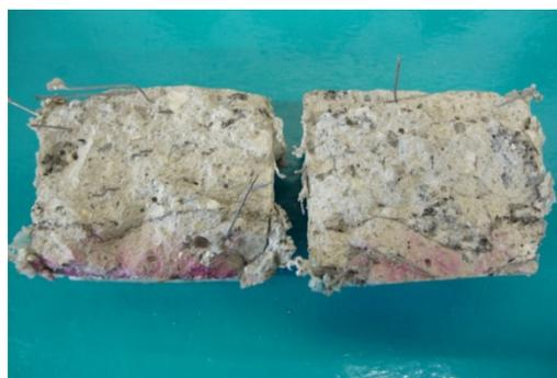
Figura 4.35 - Penetração da solução em provete de BACRFA
