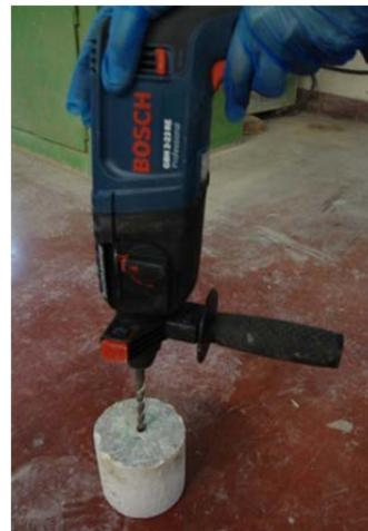
Figura 4.55 - Perfuração dos provetes
