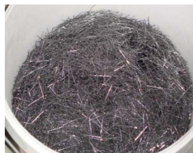
Figura 3.4 - Fibras de aço RAD 65/35 HW da Radmix
