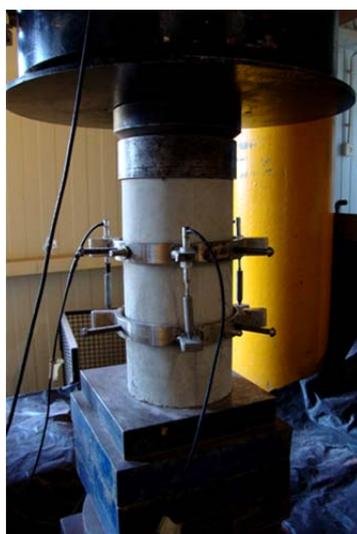
Figura 4.7 - Configuração do ensaio para determinação do módulo de elasticidade
