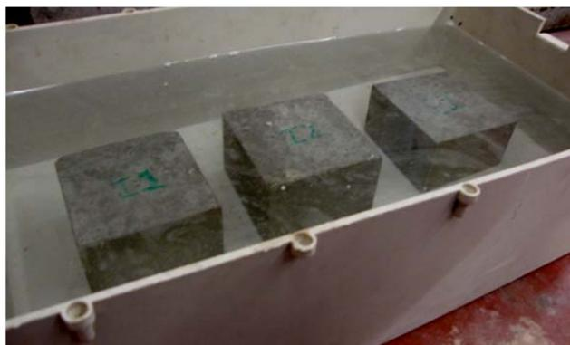
Figura 4.24 - Recipiente onde se realizaram os ensaios de absorção de água por imersão
