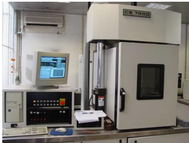
Figura 27 - Equipamento de medição do módulo.
