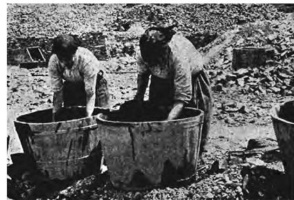
Lavagem manual em tinas do minério fragmentado, reconhecem-se no plano afastado grandes escombrelas de material grosseiro. Tratamento realizado pelo "pessoal do Quilo" nas imediações da Mina da Panasqueira. Fotografia de Vaz Leal (1945).
