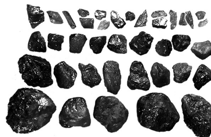
Seleção de grãos de cassiterite com maior conteúdo em estanho, vulgo “cassiterite cor-palha”, (largura do grão maior \approx 0,5cm) - concentrado de minérios de aluvião - Concessão Mineira de Junqueiro (Argas - Caminha) - Amostra de Carlos Leal Gomes; Fotografia de Pedro Alves.
