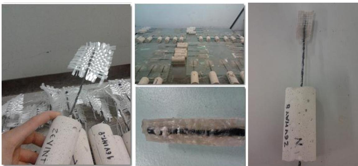
Figura 4.4 – Processo de fabrico das amarras nos varões
