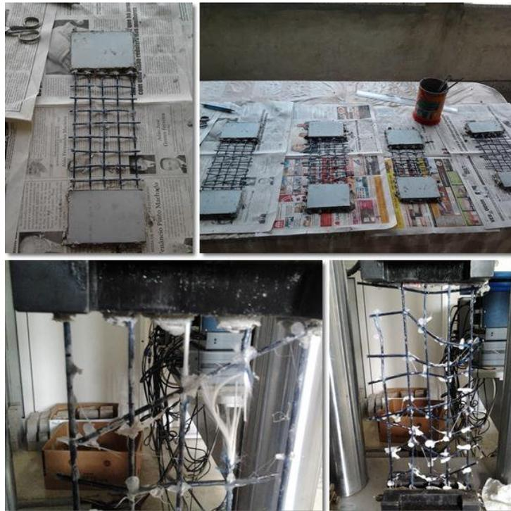
Figura 4.18 – Fabrico e ensaios de malhas à tração com amarras com Cola de Epoxi
