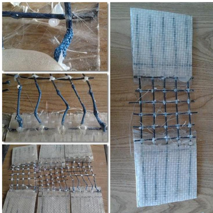
Figura 4.19 – Fabrico e resultados de malhas submetidas à tração com amarras de malha de vidro impregnada em resina poliéster
