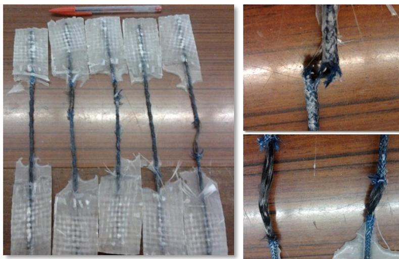
Figura 4.22 – Tipologias de rotura de varões 1evmin\_8\_carbono
