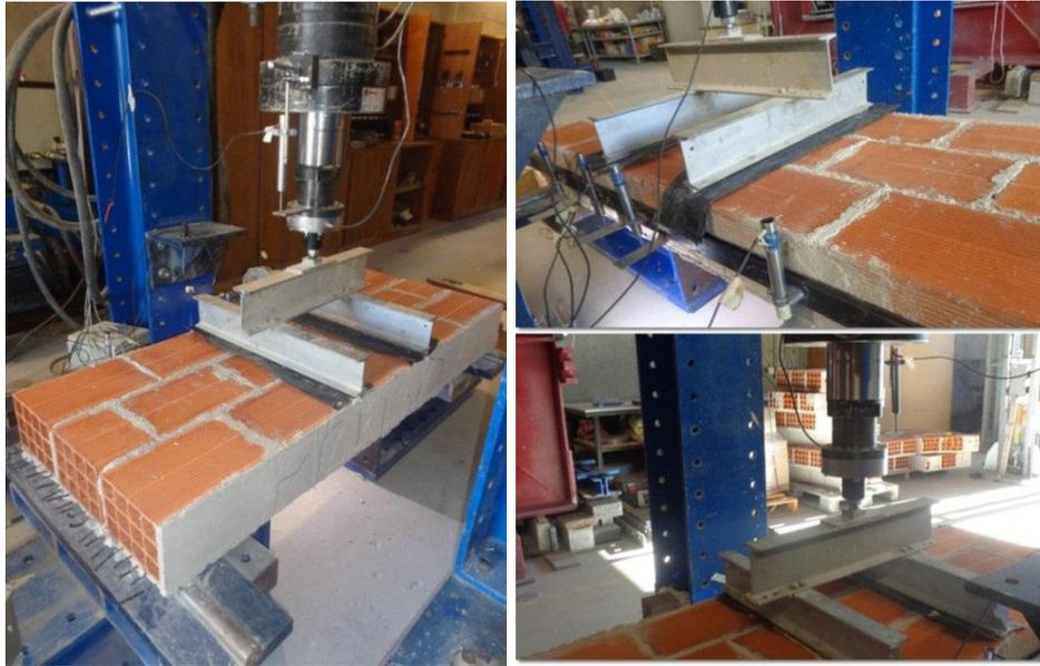
Figura 5.13 – Esquema de ensaio de flexão de paredes de alvenaria
