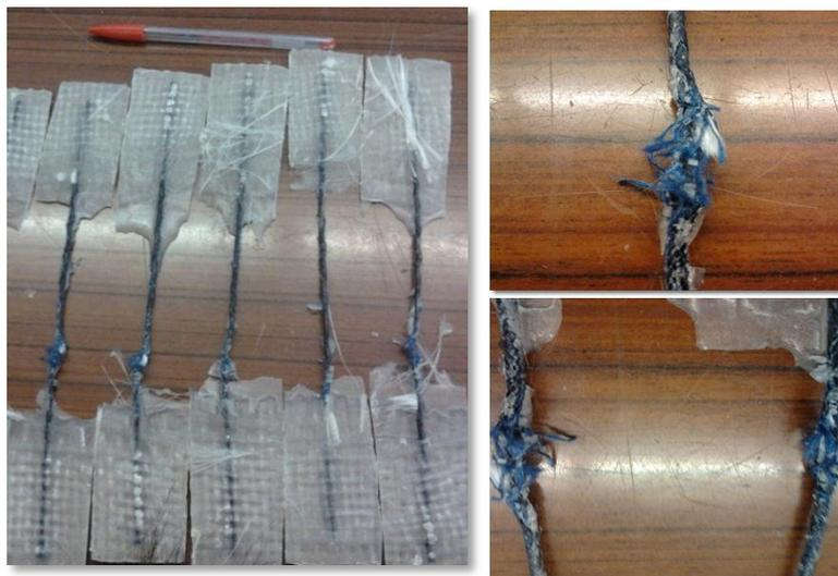
Figura 4.21 – Tipologias de rotura de varões 1evmin\_8\_vidro
