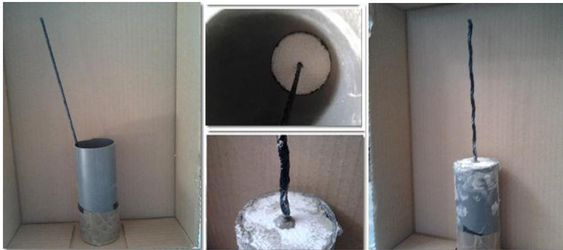
Figura 4.3 – Fabrico de provetes cilíndricos de argamassa
