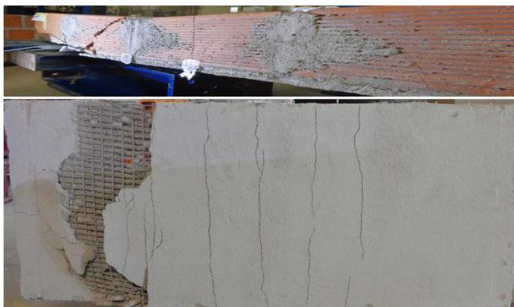
Figura 5.19 – Modo de rotura típico das paredes reforçadas com malha S&P
