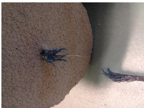
Figura 4.9 – Rotura do varão compósito sem existir rotura por aderência na série 3
