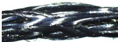
Figura 2.18 – Estrutura de entrançado de um varão composto
