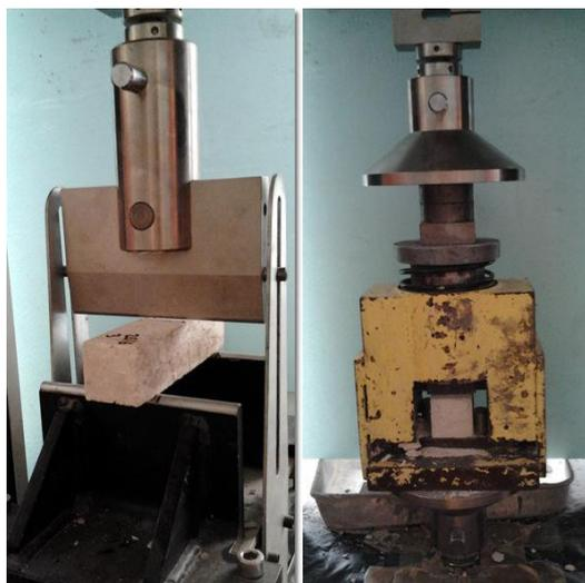
Figura 4.2 – Ensaio à flexão (esquerda) e à compressão (direita) dos provetes de argamassa aos 28 dias de cura
