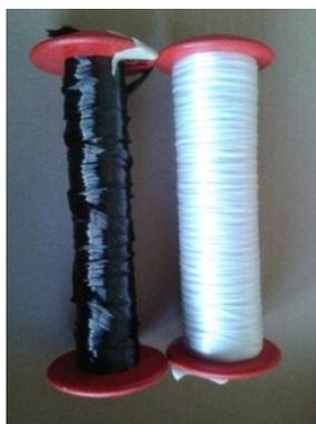
Figura 5.4 – Bobines preenchidas com fibra de carbono (esquerda) e fibra de vidro (direita)
