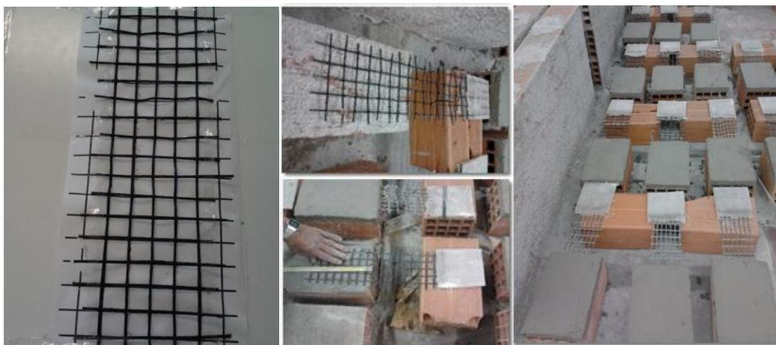
Figura 4.5 – Fabrico e aplicação de malhas para ensaio de aderência
