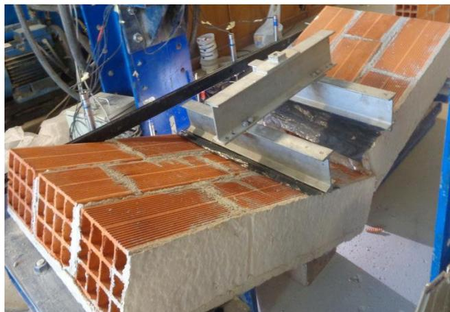
Figura 5.16 – Modo de rotura típico das paredes de referência
