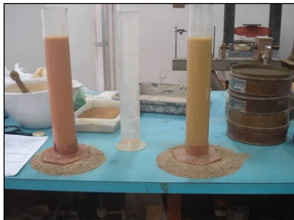
Figura 8: Imagem representativa do ensaio de equivalente de areia (Melo, 2012)
