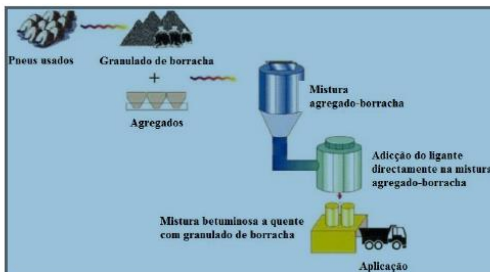
Figura 20: Etapas do processo seco de produção de betume com borracha (Neto et al. , 2006)
