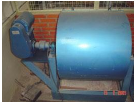
Figura 6: Representação da máquina Los Angeles (Palha, 2005)
