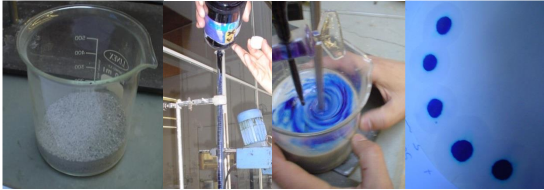
Figura 9: Representação do ensaio de determinação do valor de azul-de-metileno (Palha, 2005)
