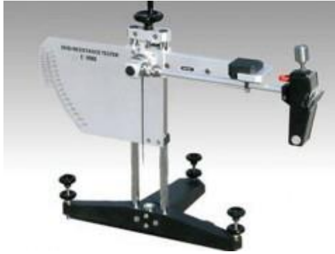
Figura 7: Representação do equipamento pêndulo britânico (Perta, 2012)
