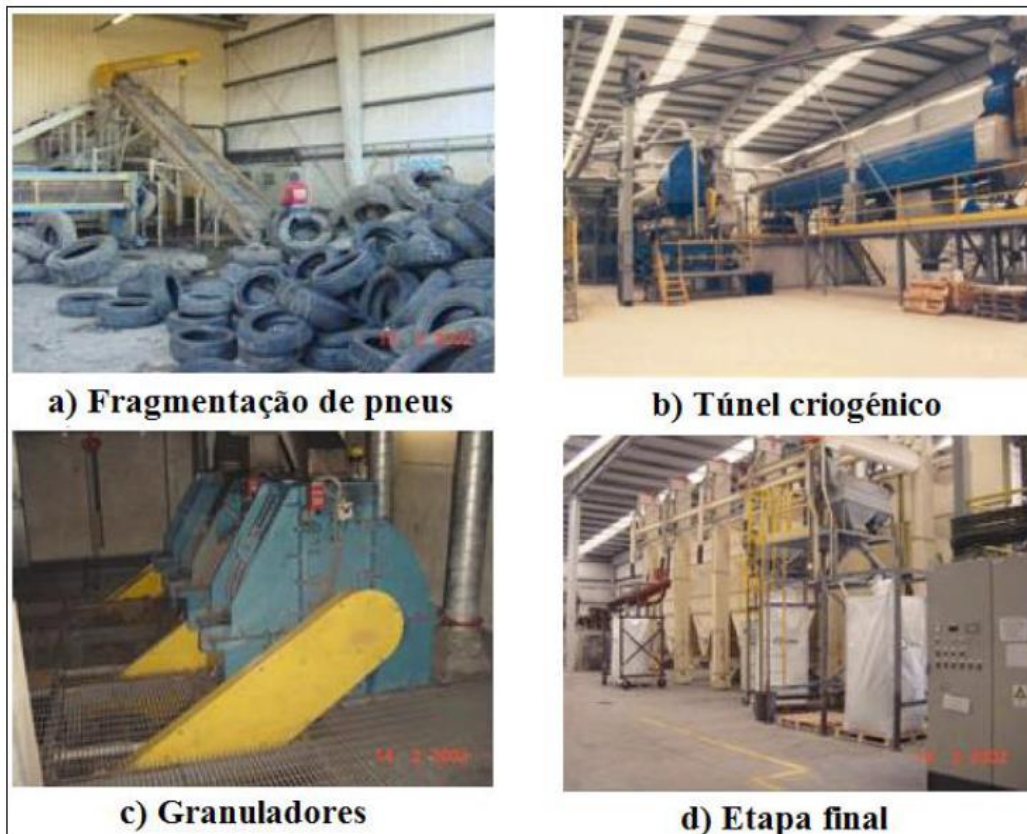
Figura 18: Processo criogénico para obter granulado de borracha (Neto et al. , 2006)
