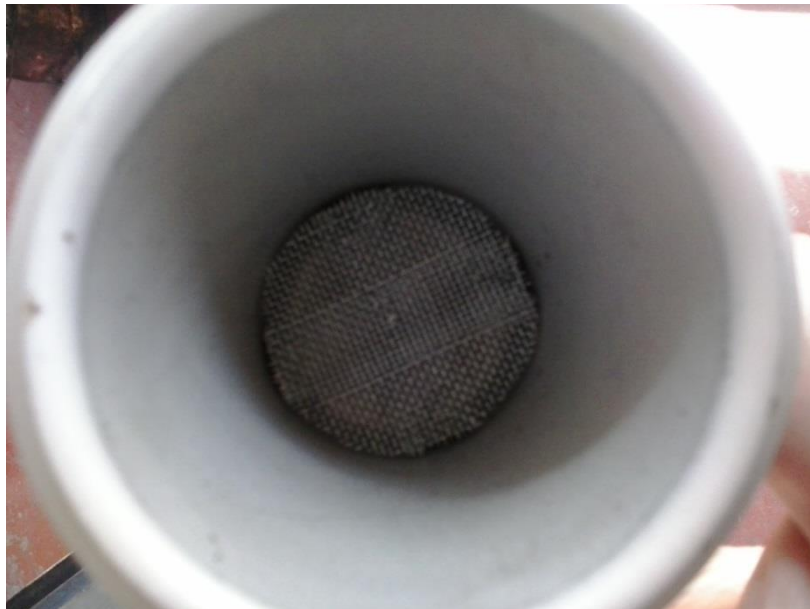
Figura 28: Sistema de separação dos componentes betume e borracha (peneiro)
