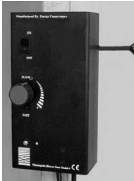
Figura 44 – Sistema APT com controlador de velocidade do equipamento “Porta Ventiladora”.
