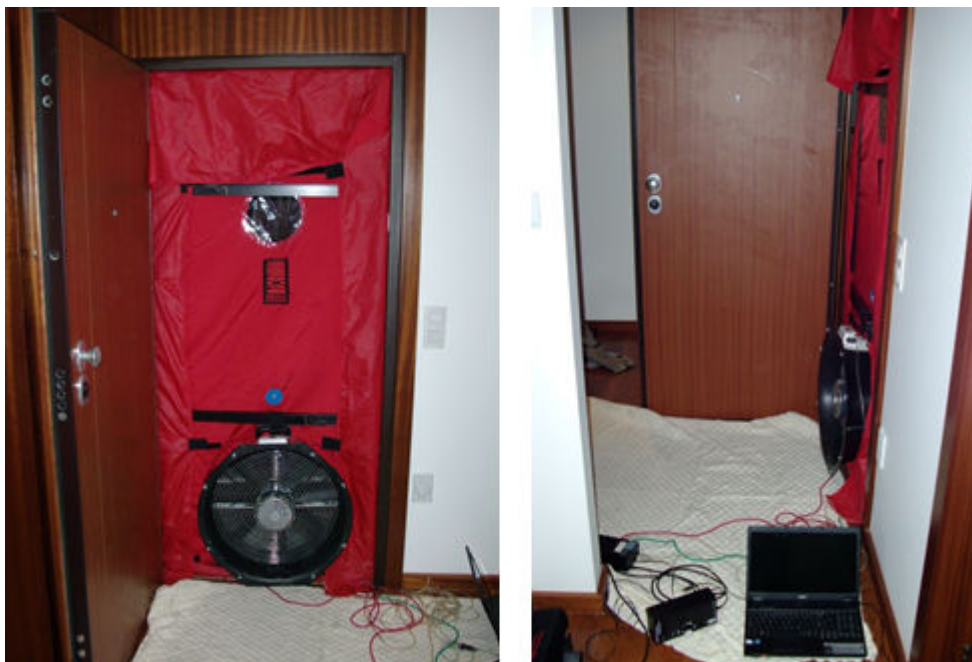
Figura 9 - Equipamentos utilizados no ensaio de pressurização, “Porta Ventiladora”.
