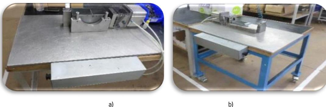
Figura 77 - Moldes de corte pneumáticos: a) Corte da base; b) corte do top
