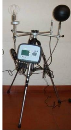
Figura I.1 - Estação de conforto.
