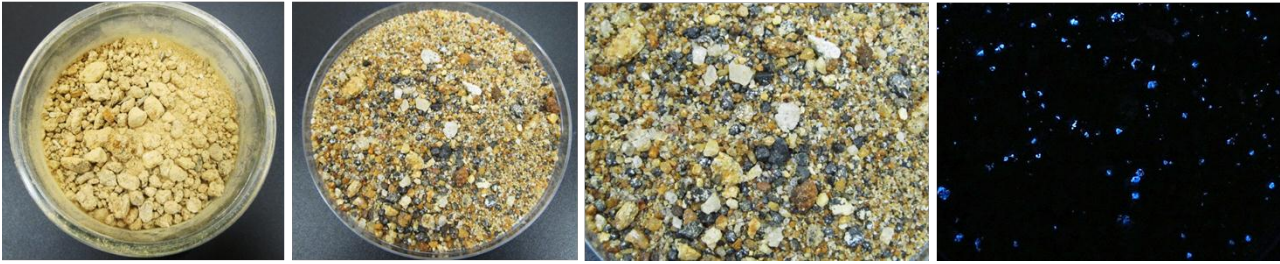
Concentrado denso a partir de materiais acumulados da Casa do Guincho (Valdarcas). Fracção grosseira de cristais e grãos compostos de scheelite-ferberite – imagem de luz natural e imagem de UV.
