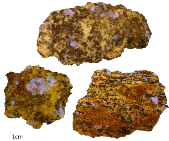
Concentrados do material amostrado do nível de sulfuretos da corta da Cerdeirinha (luz natural e luz UV). A - fracção densa superior a 2mm com separação à bateia (SCH>35%); B - fracção crivada com malha de 63µm (SCH>10%); C - fragmentos grosseiros desmembrados (o material com maior percentagem de scheelite corresponde às fases mais oxidadas - SCH>30%); D - grãos seleccionados da fracção grosseira, com cristais isolados de scheelite.
