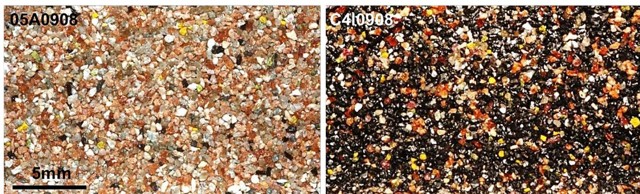
Figura V. 210. Concentrados de grãos densos das estações 05A e C4' (fracção <math><63\mu\text{m}</math>), separados em bromofórmio após tratamento com ácido.
