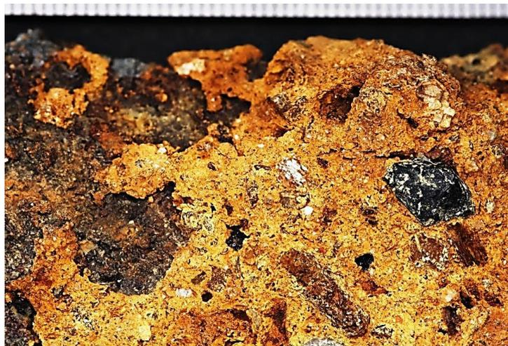
**Figura V. 212.** Amostra de uma crosta de tipo ferralítico, de Valdearcas, cuja matriz corresponde a um plasma óxido agregador. Destaca-se o elevado conteúdo da fração detrítica, nomeadamente um cristal de ferberite retido pela matriz.
