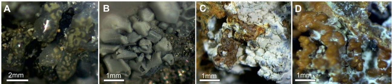
**Figura V.49.** Aspectos de alteração/instabilização da scorodite (observações em LB): **A** - marcas de corrosão – dissolução na superfície dos cristais scorodite. **B** - scorodite evoluída para kanquite; **C** - hidróxido de Fe em substituição de possível kanquite botrioidal; **D** - substituição completa pelo hidróxido de Fe, com kanquite intersticial (aquisição de morfologia botrioidal).
