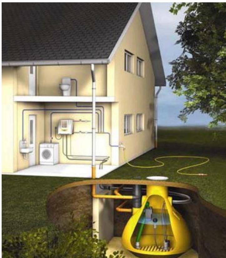
Figura 7: Esquemática de um SAAP (Ambientel, 2011)
