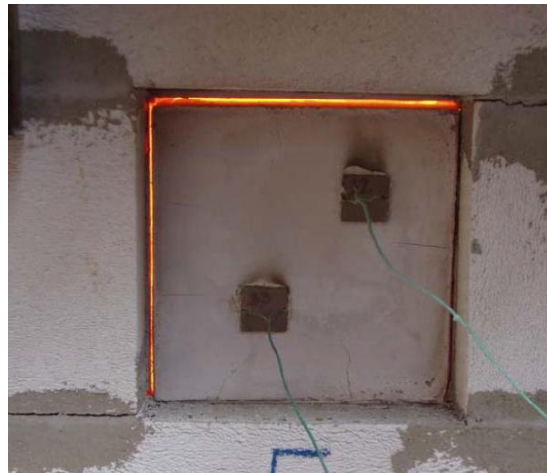
Figura 3.8 – Placas obtidas por activação alcalina sujeitas a fase térmica. São visíveis dois termopares aplicados na face posterior da placa (Pacheco-Torgal, et al., 2011).
