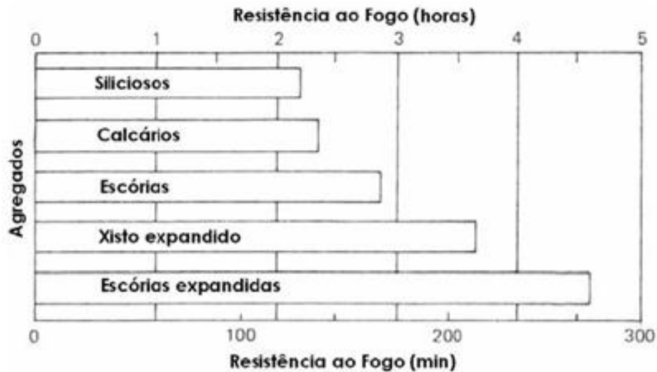
Figura 2.5 – Efeito de vários tipos de agregados na resistência ao fogo de uma placa de 12,1cm de betão de cimento Portland normal (NFPA, 1986), (Osório, 2006).
