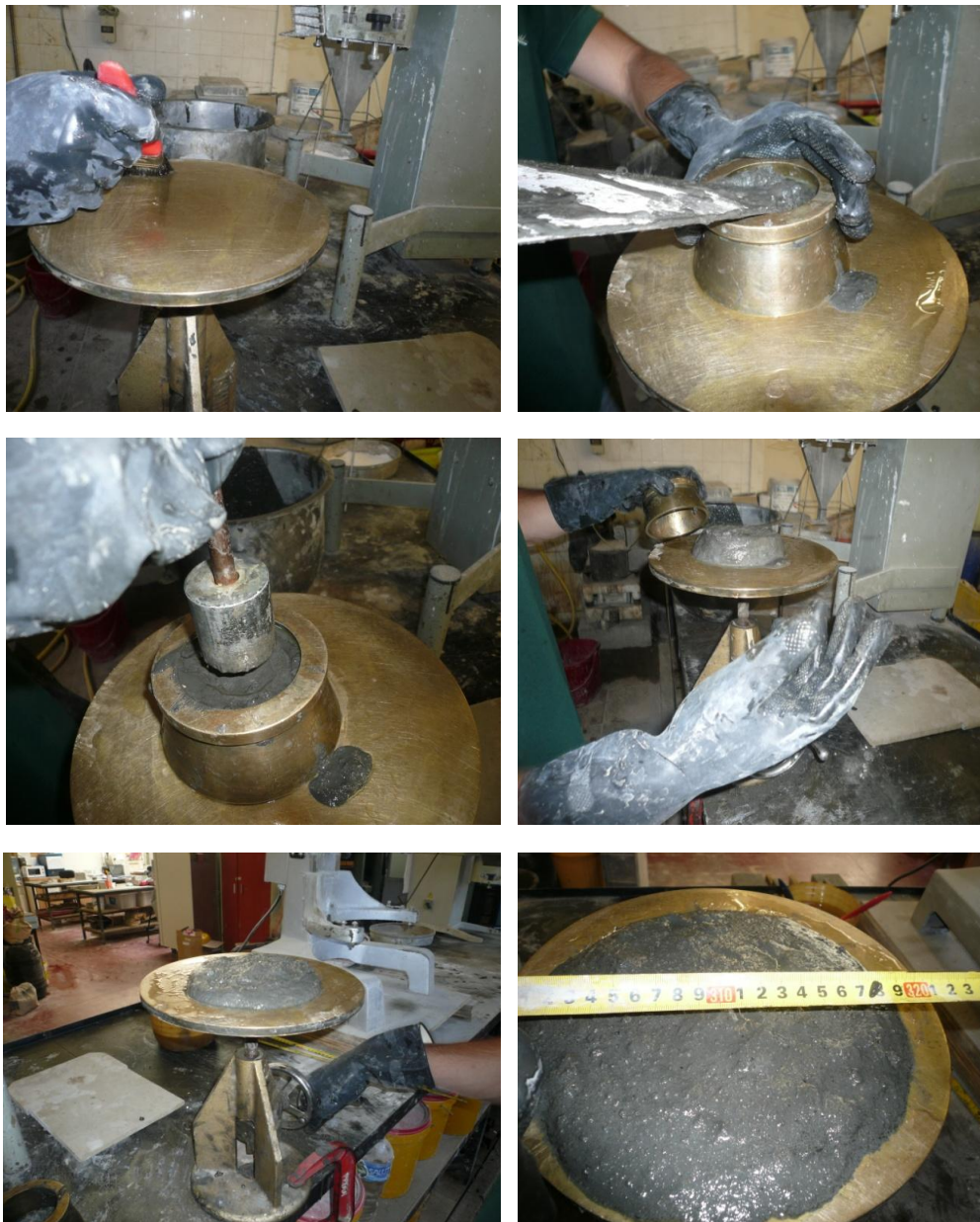
Figura 4.10 – Fases de execução do ensaio para determinação da trabalhabilidade
