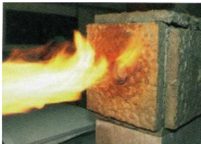
Figura 3.7 – Resistência ao fogo de placas de betão activado alcalinamente (Pacheco-Torgal, et al., 2011)
