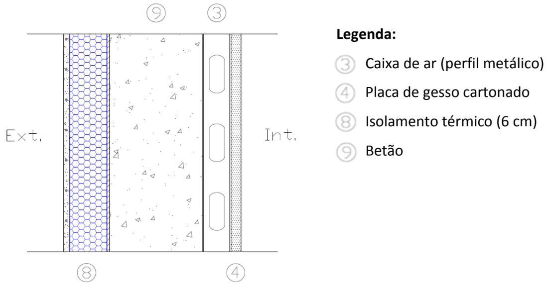
Figura 25 – Parede exterior em betão armado, com sistema de isolamento térmico pelo exterior.
