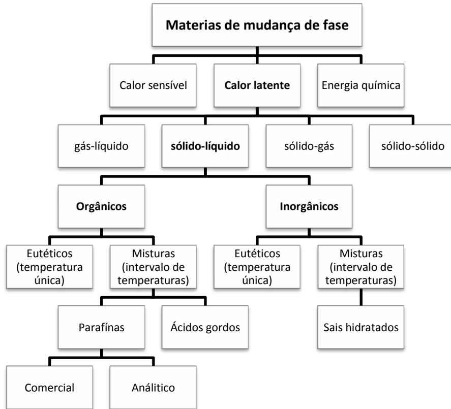
Figura 4 - Esquema de classificação de PCM [adaptado de 14].
