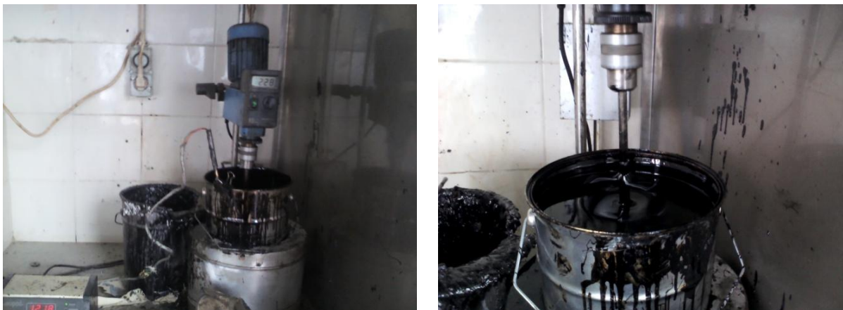
Figura 23 – Equipamento utilizado para aquecimento do betume.
