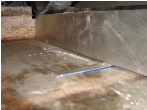
Figura 51 - Viga de alumínio com 1% de inclinação.
