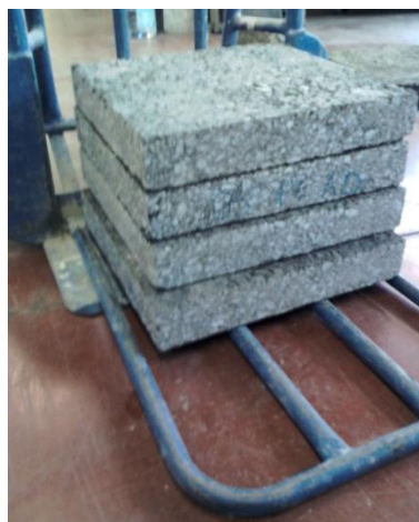
Figura 25 - Lajetas resultantes das misturas betuminosas produzidas.
