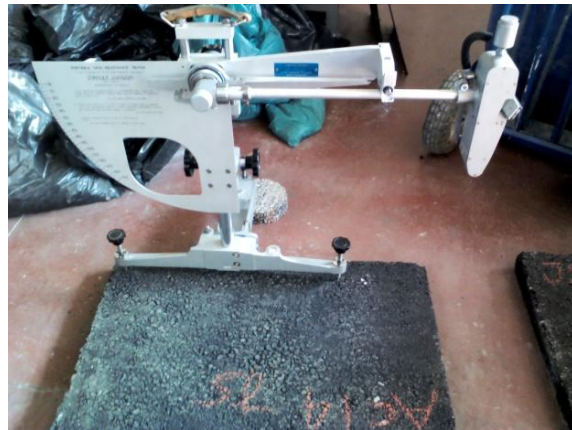
Figura 29 – Aplicação do método do ensaio de pêndulo britânico.
