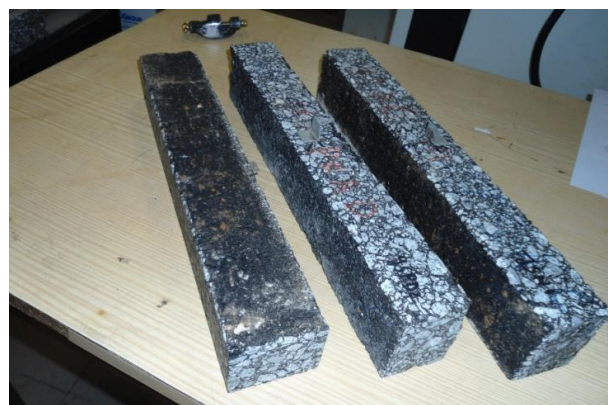
Figura 26 - Vigas resultantes de cada laje de mistura betuminosa produzida.
