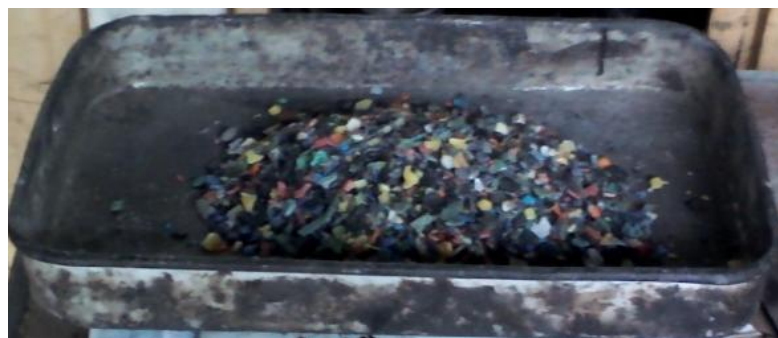
Figura 21 - Polietileno de alta densidade (PEAD) utilizado na modificação do betume para a mistura AC14PEAD.
