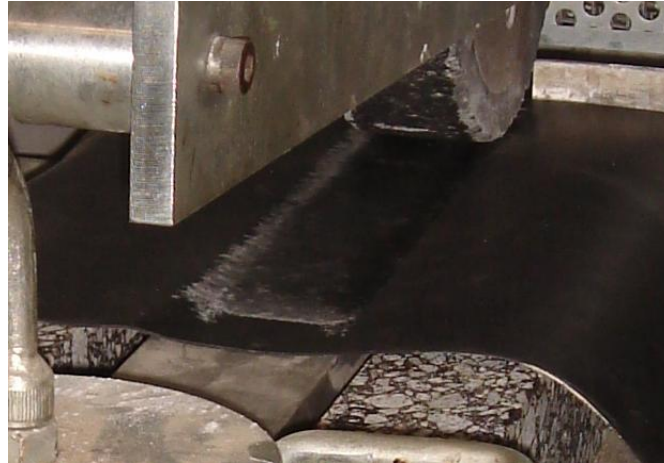
Figura 67 - Deformação da borracha imposta pelas repetidas passagens da roda.
