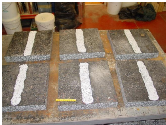
Figura 53 - Ensaio de mancha de areia localizada.
