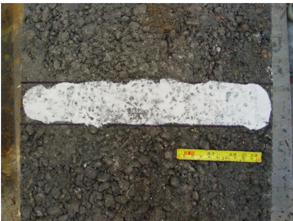
Figura 53 - Ensaio de mancha de areia localizada.
