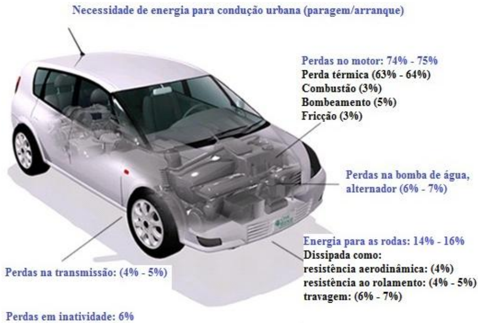
Figura 13 - Exemplo da perda de energia para um modelo de veículo de passageiros médio em condução urbana (adaptado de USDE (2012)).
