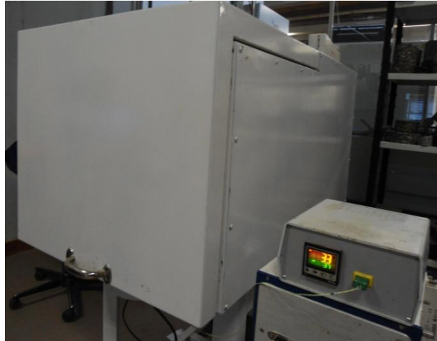
Figura 43 - Ensaio de resistência ao rolamento com aquecimento.
