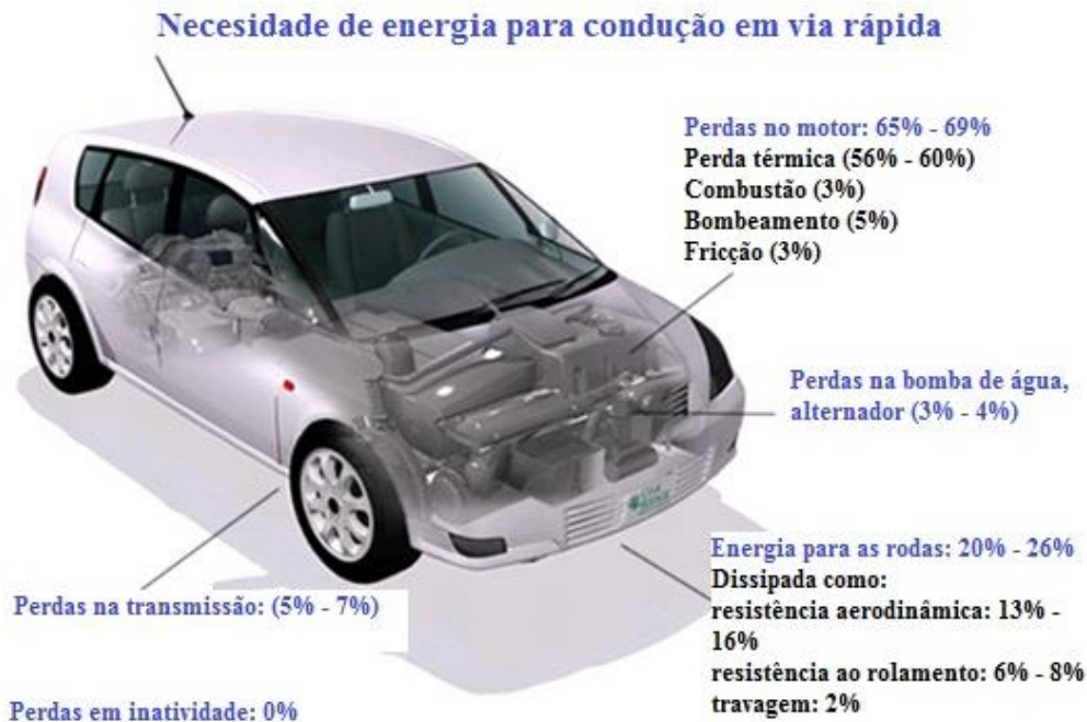
Figura 14 - Exemplo da perda de energia para um modelo de veículo de passageiros médio em via-rápida (adaptado de USDE (2012)).
