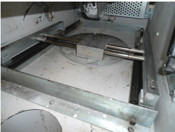
Figura 62 - Exemplo do mecanismo Scotch Yoke usado no equipamento deste trabalho.
