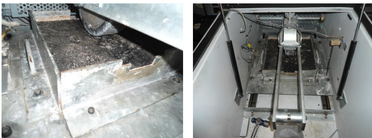
Figura 33 - Ensaio de pista ou Wheel Tracking Test .
