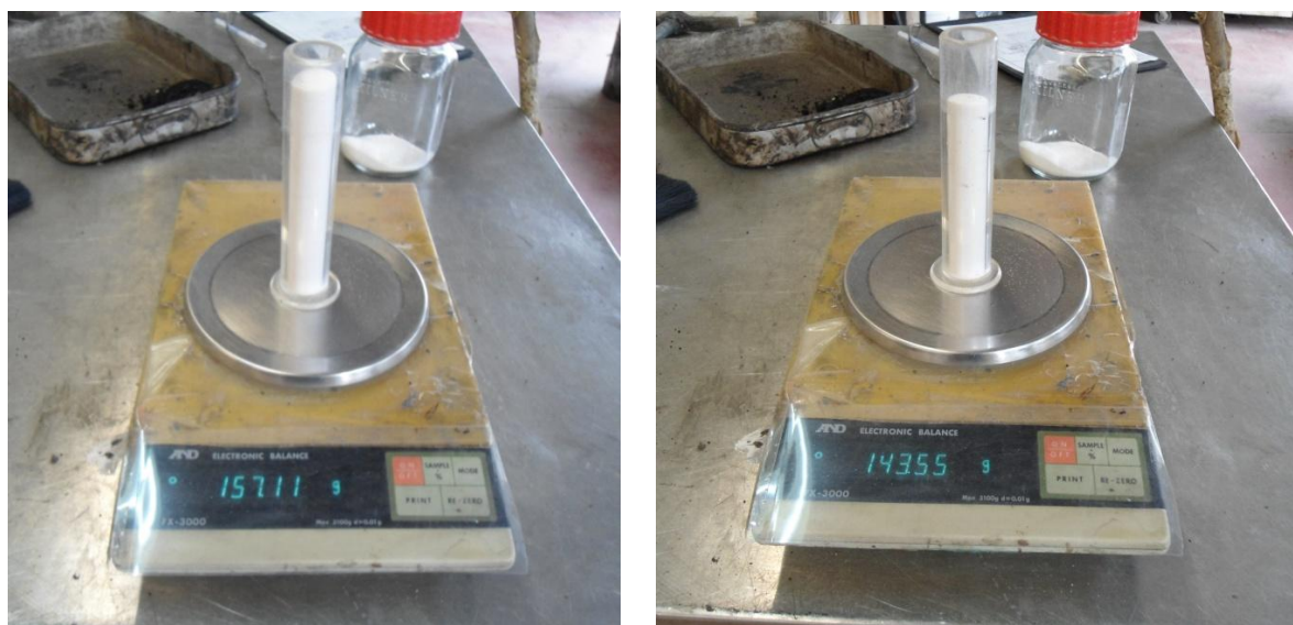
Figura 54 - Massa do recipiente com as esferas de vidro antes e após o espalhamento.
