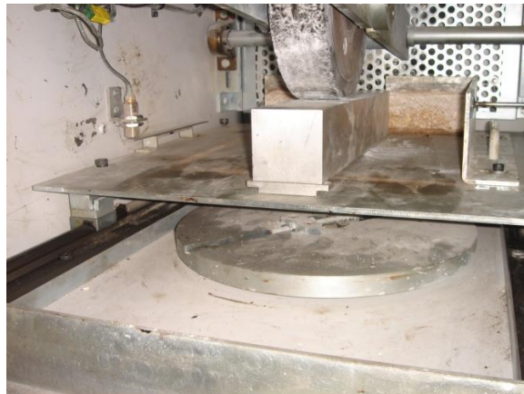
Figura 52 - Viga de alumínio com 2,75% de inclinação.
