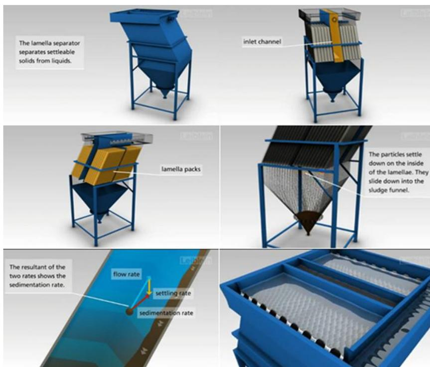
Figura 2.10- Fases do desempenho de um sedimentador de lamelas (Leiblein)
