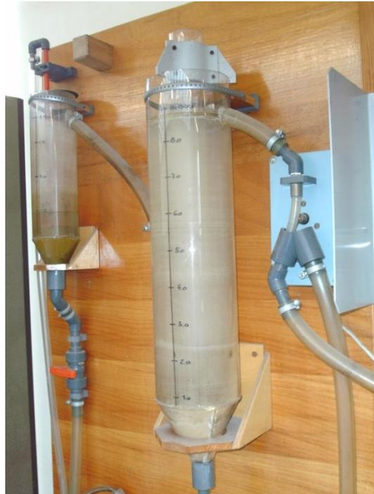
Figura 3.2- Sedimentador Primário
