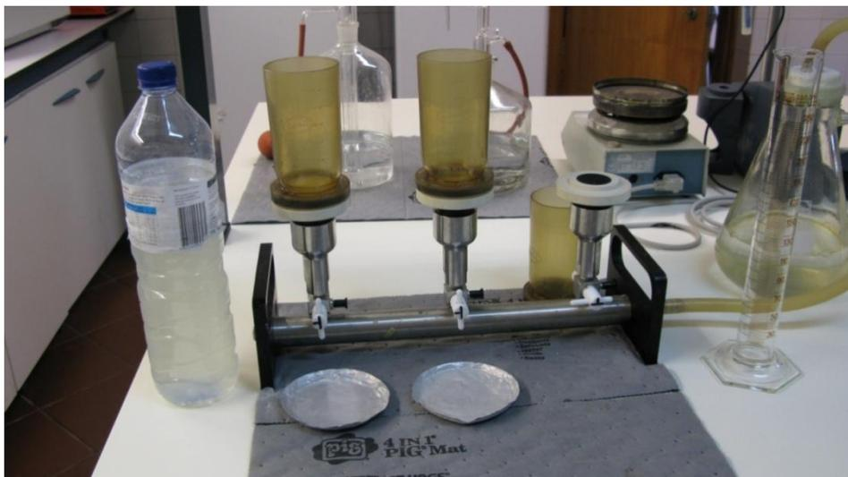
Figura 3.7- Equipamento de Filtragem AdW
