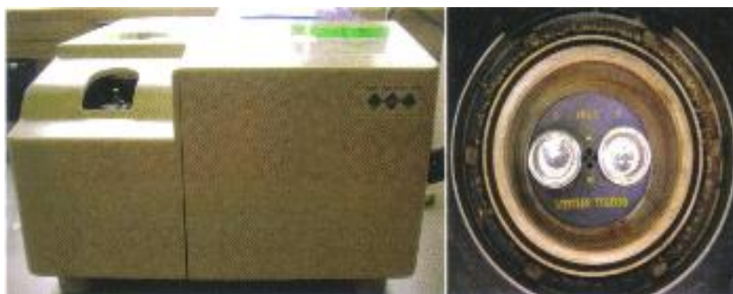
Figura 3.10 – Aparelho de DSC do laboratório de eletrólito poliméricos (Departamento de Química – UM) e o interior do respetivo forno. No forno à esquerda coloca-se a amostra e à direita o cadinho de referência.
