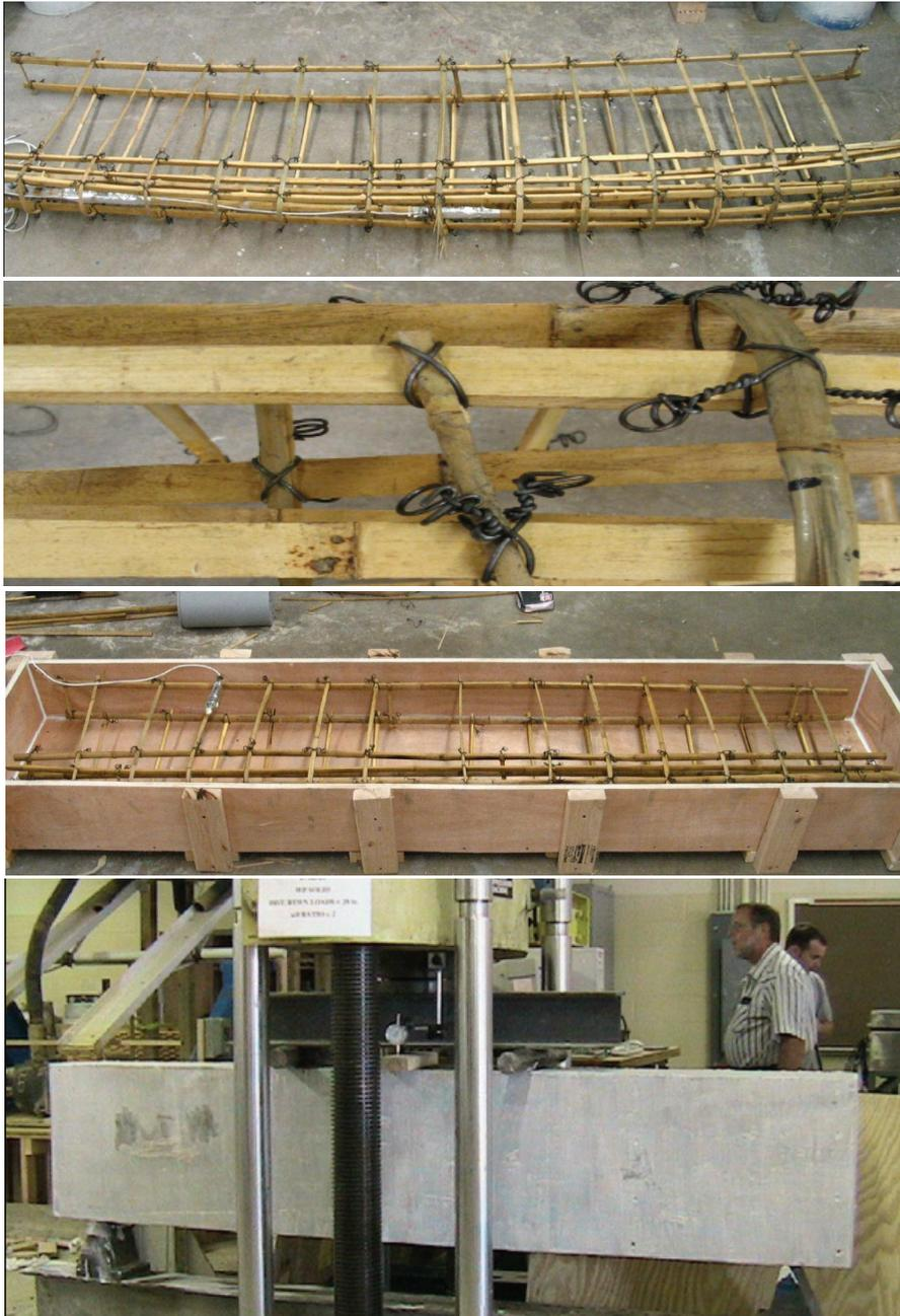
*Figura 7.8: Betão com armaduras de bambu: a) montagem das armaduras; b) pormenor das armaduras; c) cofragem; d) ensaio da viga à flexão (Khare, 2005)*
