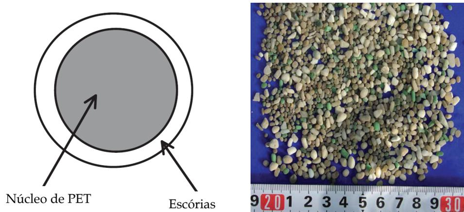
*Figura 5.21: Agregado à base de resíduos de PET e escórias de alto forno
