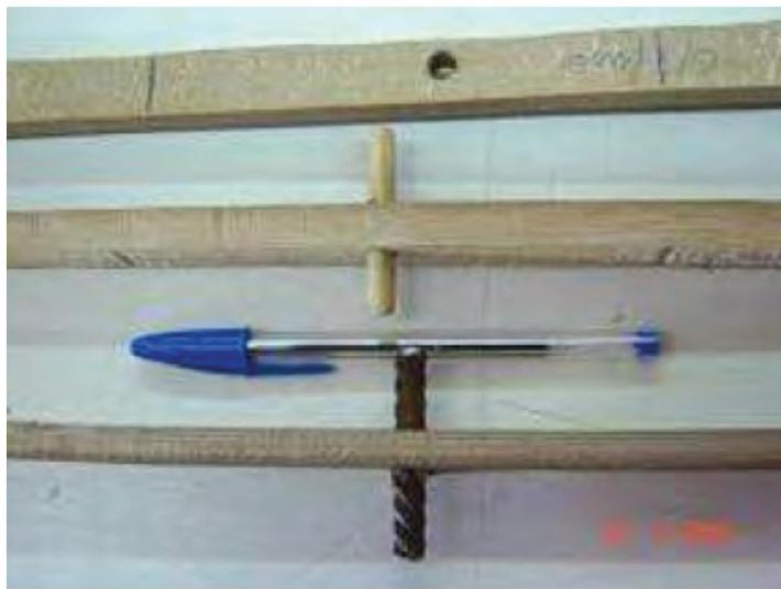
Figura 7.11: Varões de bambu, com furos e com pinos de bambu e metal (Ferreira, 2007)
