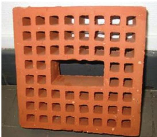
Figura 6.12: Tijolo cerâmico contendo resíduos de dragagem fluvial (Samara et al., 2009)
