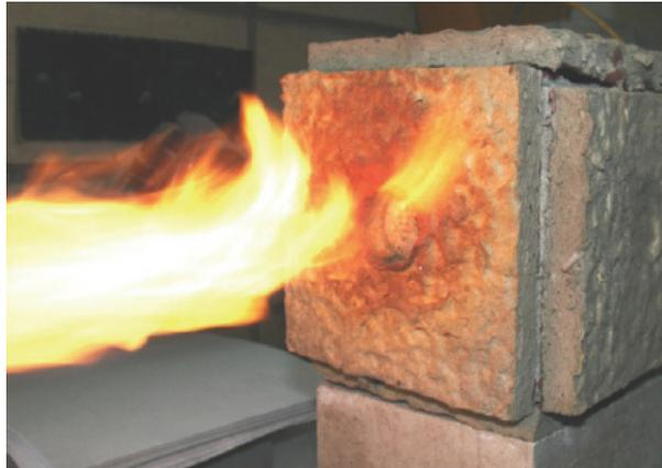
*Figura 5.39: Resistência ao fogo de placas de betão activado alcalinamente (Krivenko e Guziy, 2007)*
