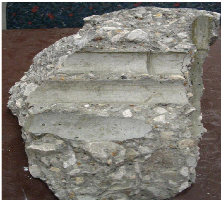
*Figura 7.9: Amostra de betão onde é visível a zona de contacto com as fibras de bambu (Khare, 2005)*
