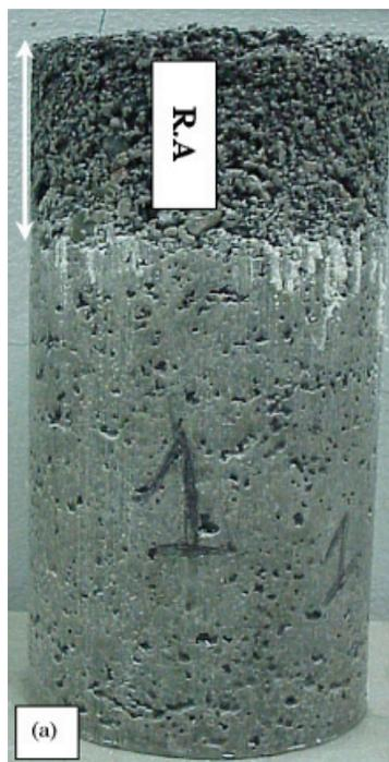
Figura 5.20: Provede de betão com agregados de borracha localizados na parte superior (TURATSINZE & GARROS, 2008)
