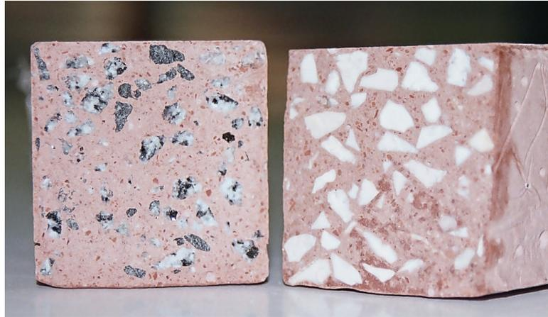
Figura 5.45: Secção de provete de argamassa AALRM após ensaio de flexão
