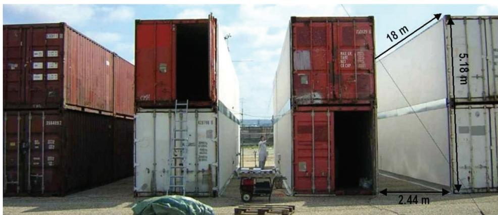
*Figura 10.14: Modelo de rua em formato reduzido para avaliação de degradação de poluentes atmosféricos por acção fotocatalítica (PICADA, 2006)*
