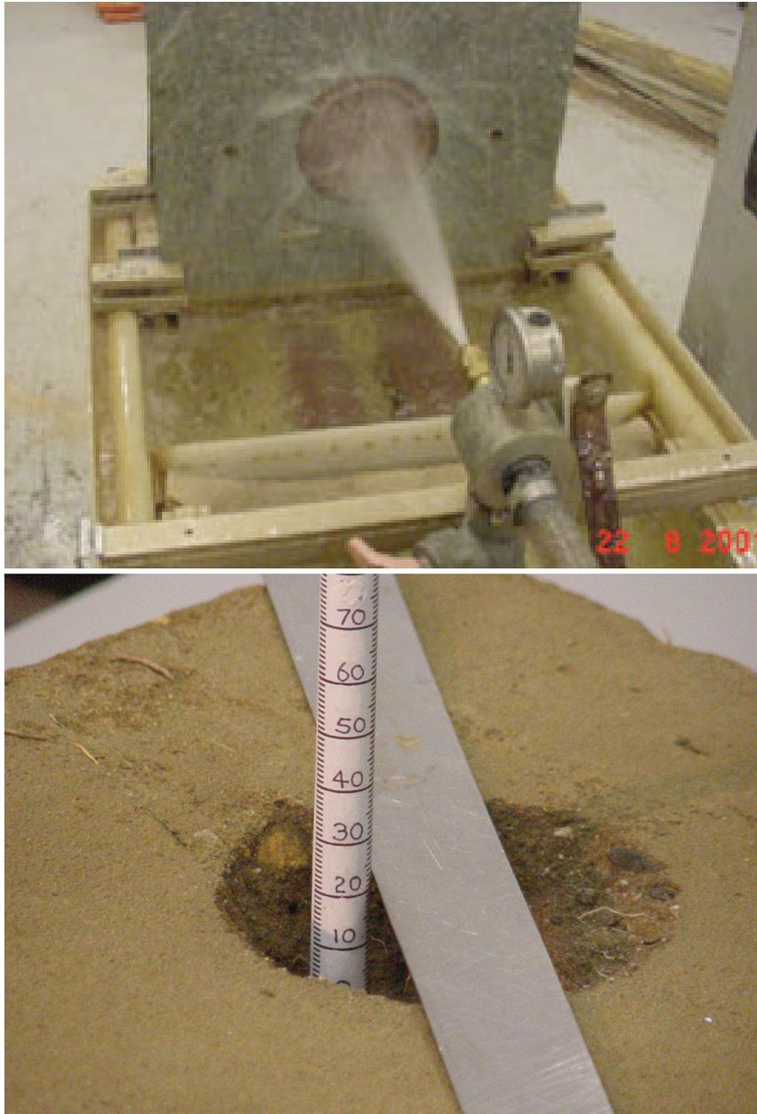
*Figura 8.22: Ensaio acelerado de erosão UTS (Heathcote & Moore, 2003)*
