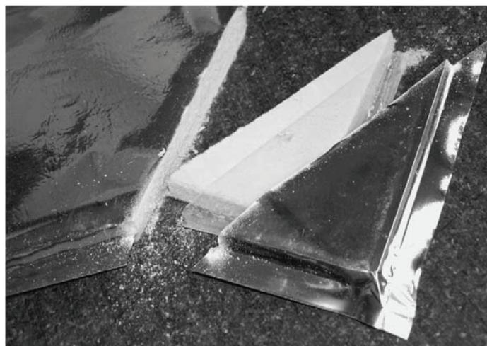
**Figura 3.13:** Secção de um painel de isolamento com vácuo (Simmler & Brunner, 2005)
