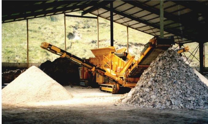
Figura 4.7: Central de trituração e separação de resíduos de placas de gesso cartonado
