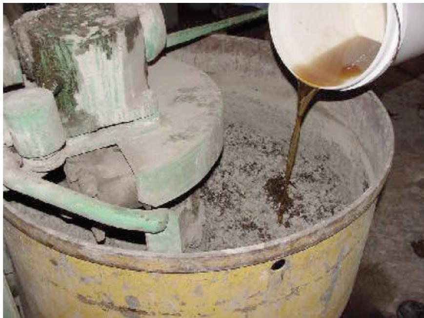
Figura 5.36: Adição do activador aos componentes sólidos (Sumajow e Rangan, 2006)
