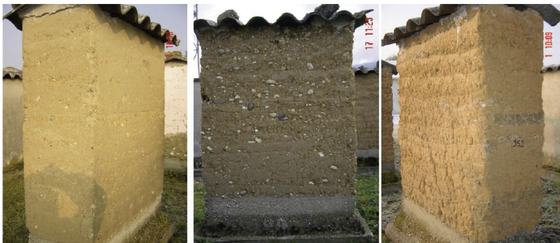
*Figura 8.20: Troços de paredes de taipa expostos durante 20 anos aos agentes atmosféricos: a) Pareda em terra estabilizada com 5% de cal; b) Pareda em terra sem estabilização (solo misturado); c) Pareda em terra sem estabilização (Bui et al., 2008).*
