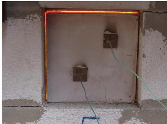
*Figura 5.40: Placas obtidas por activação alcalina sujeitas a fase térmica. São visíveis dois termopares aplicados na face posterior da placa (Perna et al., 2007)*
