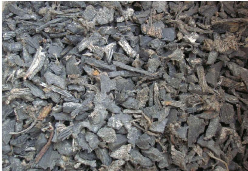
*Figura 5.16: Agregados de borracha reciclados à saída do processo de trituração (AIELLO & LEUZZI, 2010)*
