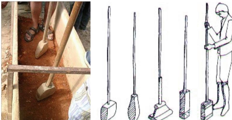
*Figura 8.10: Pilões ou maços utilizados na taipa tradicional*
