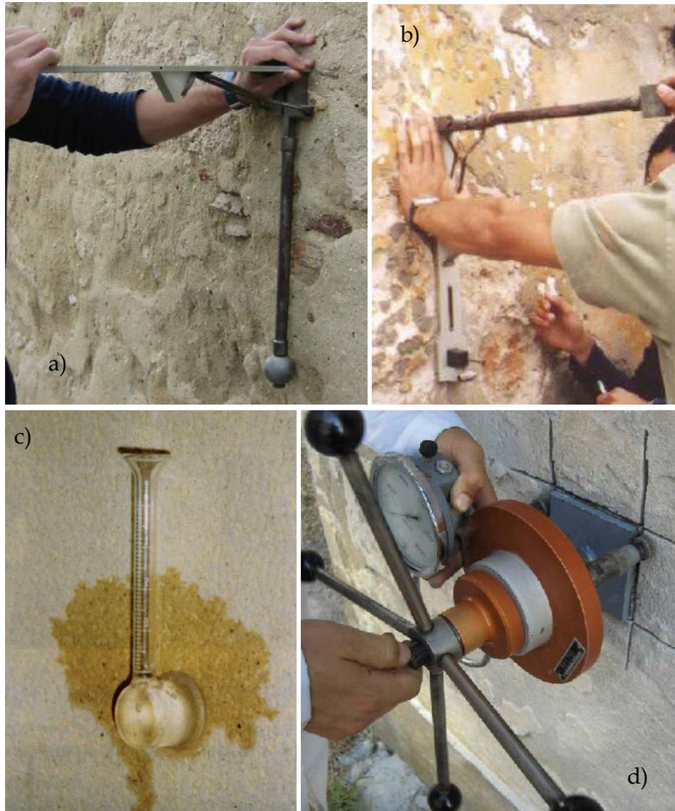
**Figura 9.26:** Ensaios de caracterização de argamassas "in situ": a) ensaio de choque de esfera; b) ensaio de penetração controlada; c) ensaio de tubo carsten (Veiga, 2003); d) ensaio de resistência ao arrancamento (Flores-Colen et al., 2007).
