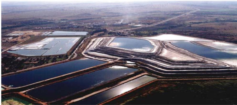
*Figura 5.32: Lagoas de sedimentação de fosfogesso*
