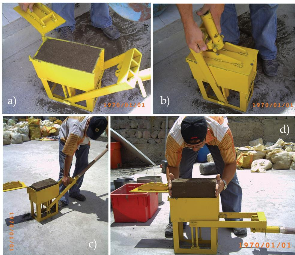
*Figura 8.17: Execução de BTC com a prensa Cinva-ram: a) Enchimento da câmara com terra; b) confinamento da mistura; c) elevação do BTC; d) retirada do BTC*
