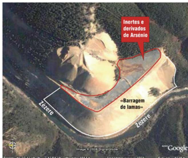
**Figura 1.17:** Minas da Panasqueira: Depósito de lamas contaminadas, localizado na zona do Cabeço do Pião, concelho do Fundão
