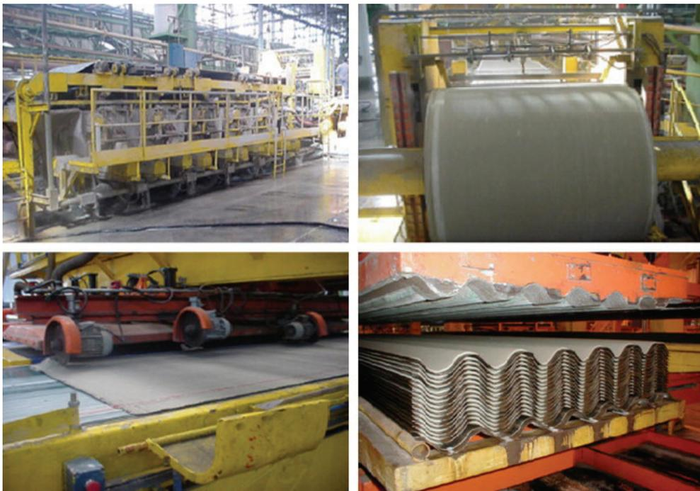
*Figura 7.2: Produção de materiais compósitos de fibrocimento pelo processo Hatscheck (Ikai et al., 2010)*
