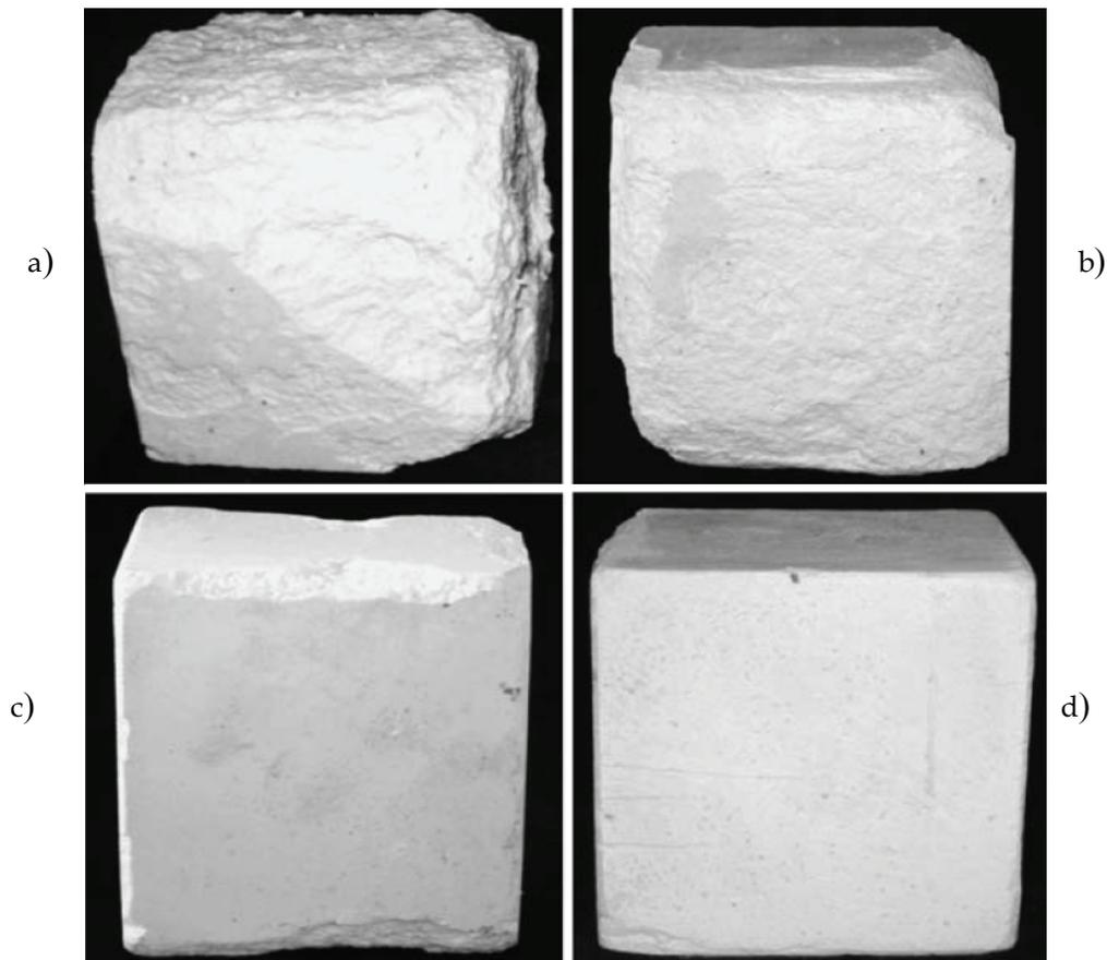
*Figura 6.19: Aspecto dos provetes após 50 ciclos do ensaio de gelo-degelo segundo a percentagem de resíduos de vidro em pó-RVP na composição: a) Composição sem RVP; b) Composição com 10%; c) Composição com 20%; d) Composição com 30% (Turgut, 2008)*
