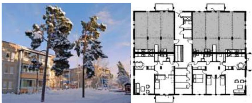
Figura 4.51: Skarne 66 system: vista do complexo habitacional e imagem das plantas sem e com as partições (Disponível em: <http://www.afewthoughts.co.uk/flexiblehousing>).
