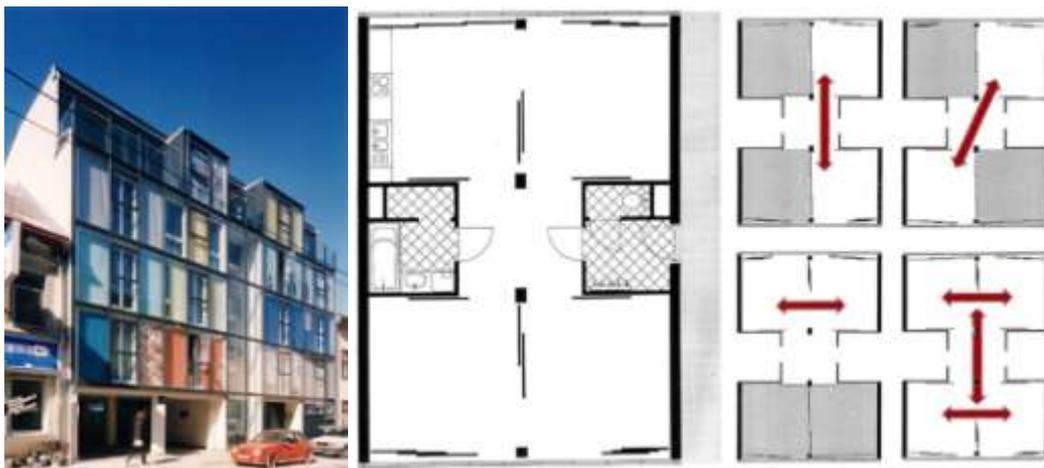
Figura 4.5: Edifício em Grieshofgasse: a) Vista exterior do edifício; b) Planta tipo; c) Combinações espaciais possíveis (Disponível em: <http://www.ats-architekten.at/wimmer/index.htm>).
