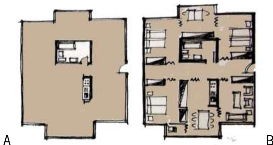
Figura 3.14: Habitação evolutiva e adaptável: Planta “A”, proposta de organização espacial inicial de entrega, sem revestimentos e portas interiores e com uma cozinha mínima. Planta “B”, fase inicial de ocupação com compartimentação através de mobiliário e cortinas (adaptada de COELHO & CABRITA, 2003).
