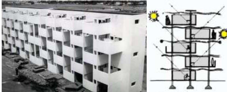
Figura 4.71: Bloco residencial ATBAT: projeto na fase final da obra (Disponível em: <http://www.e-flux.com/journal/view/59>); corte vertical com estudo da iluminação solar (adaptado de SHERWOOD, 1983).
