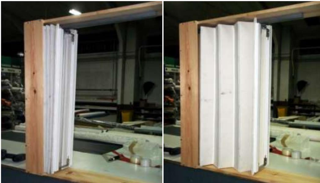
Figura 6.34: O protótipo da divisória FWS, sem acabamento, na fase de teste: posição aberta e fechada
