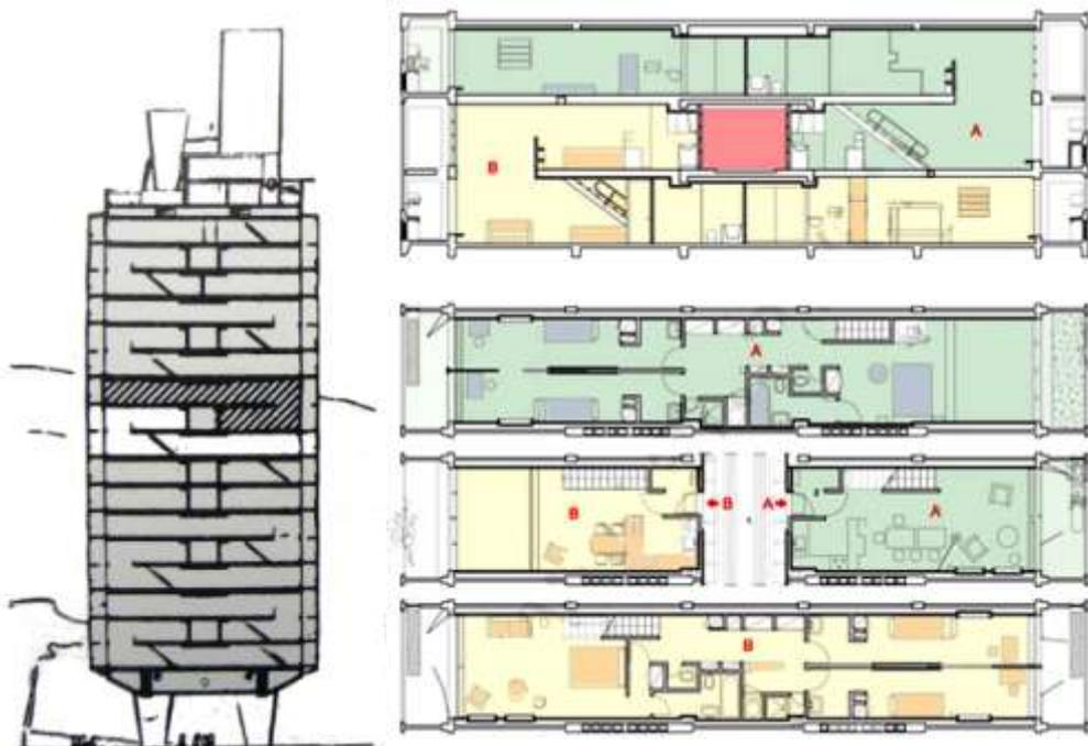
Figura 4.70: *Unité de Habitation* : corte vertical da (SHERWOOD, 1983); corte vertical e plantas da tipologia duplex (adaptado de BOESIGER, 1971).
