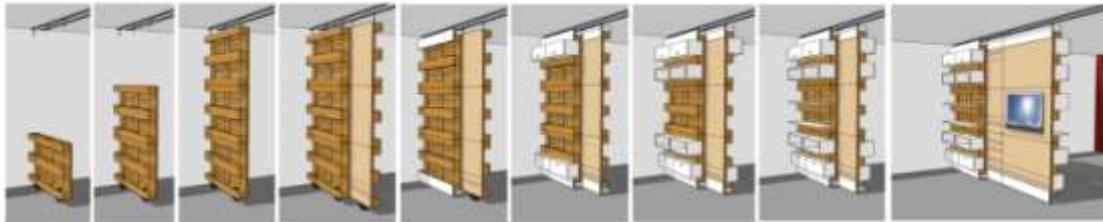
Figura 19: Evolução na montagem prefabricada de uma divisória MPW (da autoria de Alex Davico).
