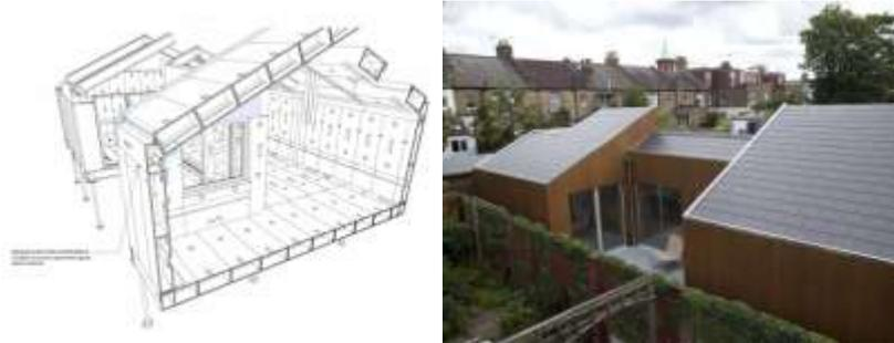
Figura 4.93: Elementos numerados pelo programa aplicado ao conceito *Facit Homes* e vista exterior da habitação (Disponível em: <http://www.3ders.org/articles/20120116-digitally-fabricated-houses-of-facit-homes.html>).
