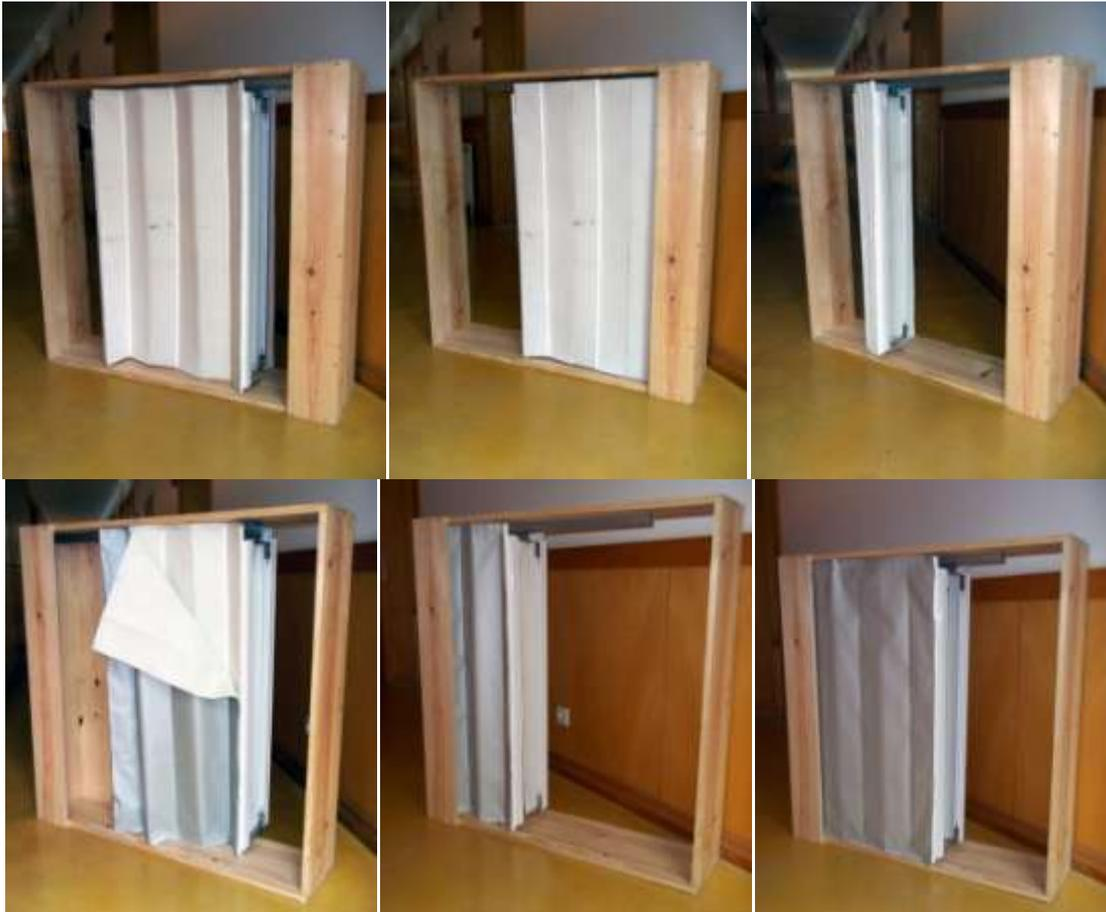
Figura 6.35: O protótipo a escala real de tamanho reduzido da divisória FWS, na fase de teste estrutural, aplicação do revestimento de acabamento e comportamento ao abri e fechar.
