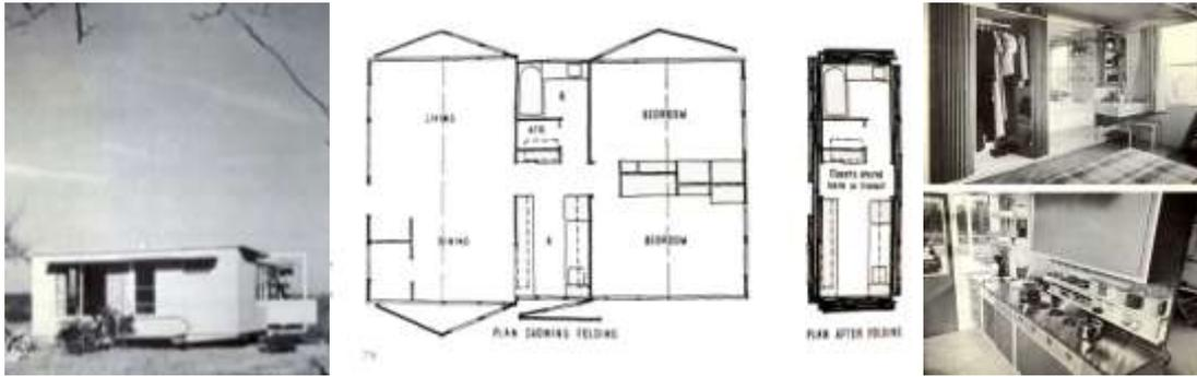
Figura 4.38: Acorn House Unfolds: a) Vista do exterior; b) Planta aberta e fechada; c) Imagens do interior (KRONENBURG, 1995).
