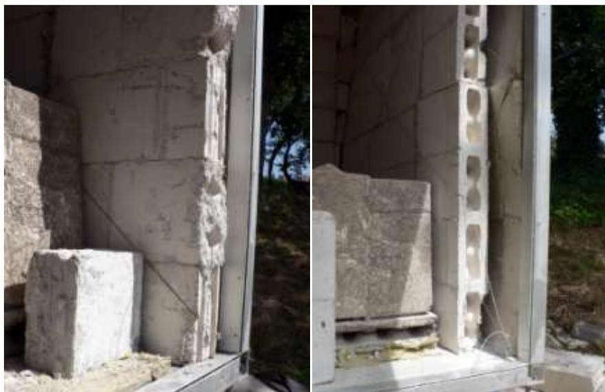
Figura 6.53: Célula de Teste: a parede de blocos antes e depois de aparada.
