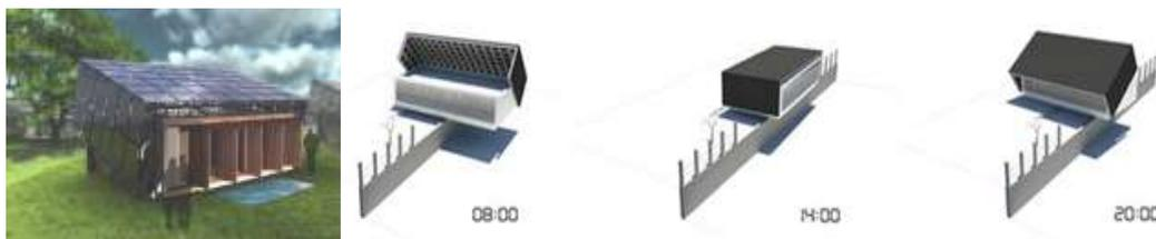
Figura 4.40: Cem+Nem-Casas: a) Render do projeto; b) Esquema do movimento rotatório ao longo do dia (PIRES, 2012).
