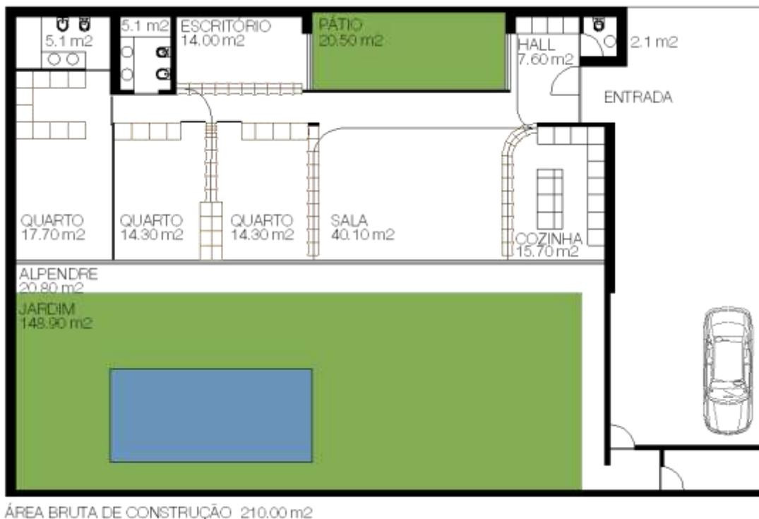
Figura 6.38: Casa do Pinhal: planta com a aplicação de sistemas de compartimentação leves e flexíveis: FWS, mobiliário/partição e painel/parede.
