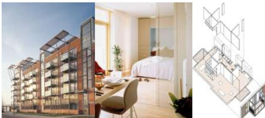
Figura 4.63: Proctor and Matthews Architects: vista exterior, imagem do interior e axonometria das partições deslizantes (Disponível em: <http://www.afewthoughts.co.uk>).
