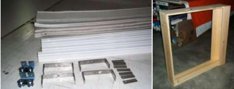
Figura 6.33: FWS: a) Os componentes necessários para a montagem do fole; b) Aro em madeira para o teste funcional.
