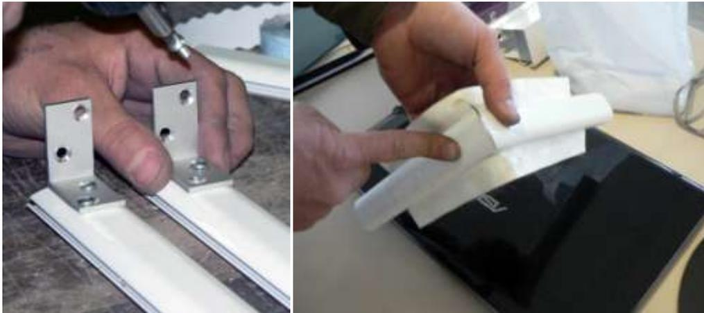
Figura 6.50: FWSF: fixação dos cantos do perfil em alumínio e ensaio do comportamento cabo de borracha para a mudança de percurso.
