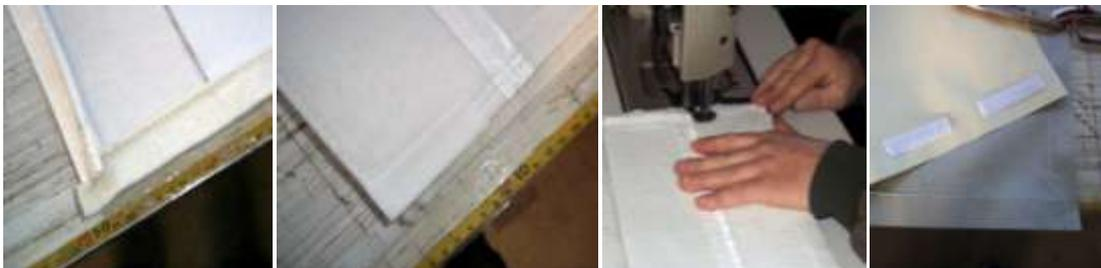
Figura 6.32: FWS: primeira fixação da tira de poliéster macio; colagem, na face exterior, do velcro sobre o poliéster prensado; costura e fixação final do velcro e do poliéster macio; costura do velcro sobre a lona microperfurada de revestimento final.
