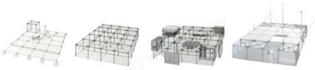
Figura 4.26: Evolução da montagem dos elementos modulares da Yacht House I (HORDEN, 1995).
