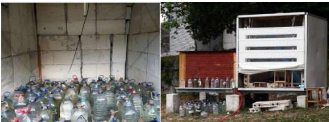
Figura 6.55: Ensaio FWSF: quarta campanha com a adição de massa térmica no início do dia e a sua remoção doze horas depois.
