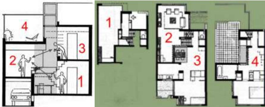
Figura 1.9: Diagoon House: a) Seção explicativa do sistema espacial; b) Plantas com os quatro níveis funcionais (Disponível em: <http://www.afewthoughts.co.uk>).
