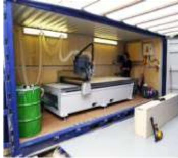
Na obra é colocado um contentor que contém uma máquina fresadora *CNC* que corta e numera no local os elementos de compensado que serão utilizados para a criação dos elementos construtivos. A serradura é reciclada para obter calor e energia.
