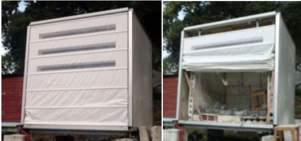
Figura 6.54: A *Folder Wall System Facade* montada na Célula Teste: o sistema fechado e aberto para a preparação de um ensaio.
