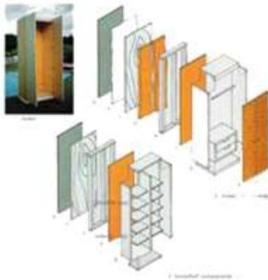
As unidades móveis são a estrutura da casa. As fachadas expostas aos elementos meteorológicos, são protegidas por um painel impermeabilizante. As unidades interiores têm um acabamento de madeira natural. As dimensões das unidades são 240cm de altura por 90cm de largura, com uma profundidade de 45cm. Uma unidade individual, que pesa cerca de 79,2kg, pode ser facilmente manipulada por duas pessoas (BAN, 2012).
