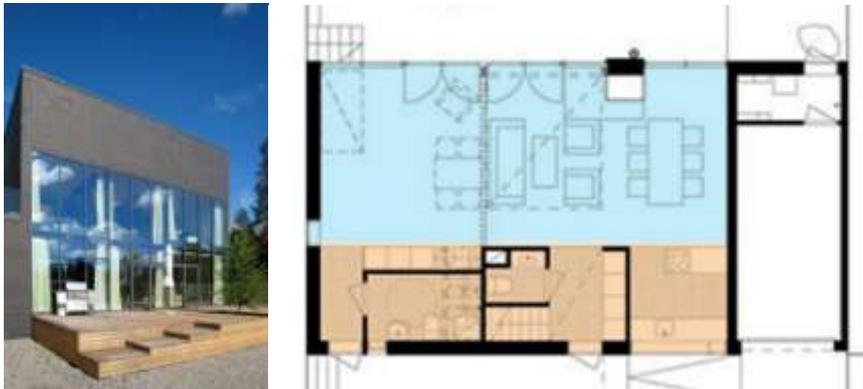
Figura 4.10: Villa Flexible: vista da fachada envidraçada e da planta do piso térreo, em rosa a área compartimentada com os serviços e em azul a sala open space (Disponível em: <http://www.avan.to/flex/flex.htm>).
