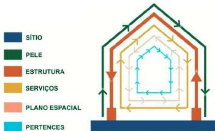
Figura 1.14: Diagrama da composição arquitetônica por cinco camadas a partir do modelo de Brand (LIZIANE, 2012).
