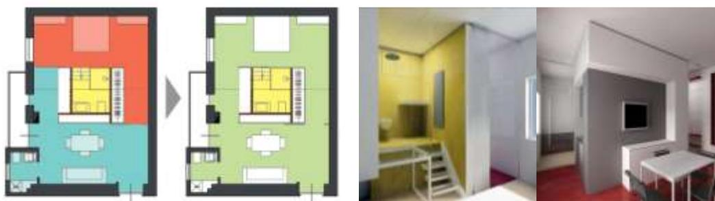
Figura 4.65: Projeto de reabilitação *Blocco Totale*: a) duas configurações em planta; b) render dos interiores (Disponível em: <http://www.bmqquadro.com>).
