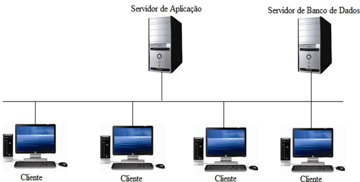
Figura 18: O Modelo de Desenvolvimento em Três Camadas.
