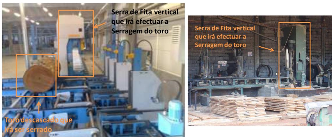
Figura 17 - Serragem do toro (corte) - imagens recolhidas das visitas efectuadas e do website da empresa fornecedora de ferramentas de corte para trabalhar madeira J.F.J.
