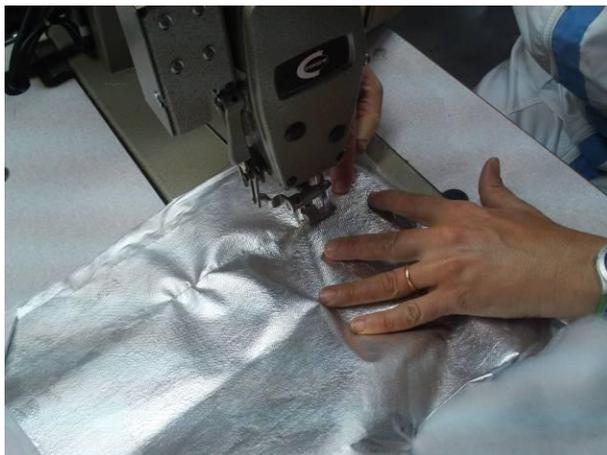
Figura 57 – União por tecnologia convencional da estrutura multicamada
