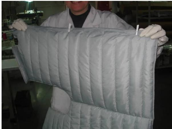
Figura 40 - União dos componentes do blusão após incorporação do aerogel
