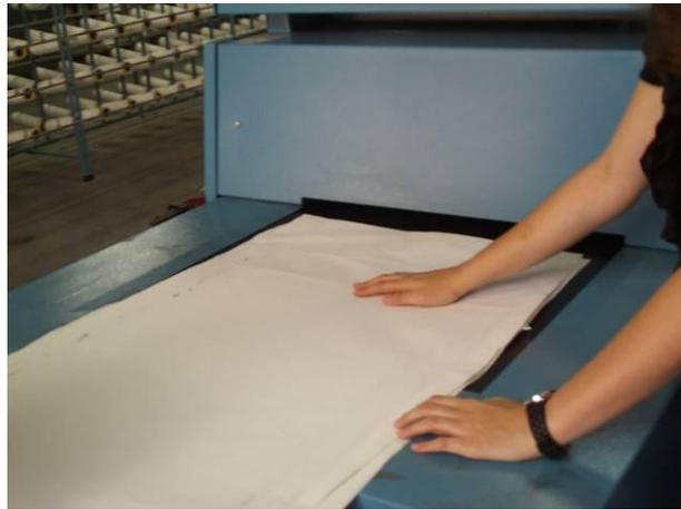
Figura 53 – Laminagem da membrana metalizada com não-tecido compacto através de um adesivo copoliéster em forma de rede - 8g/m<sup>2</sup> (AB-TEC)
