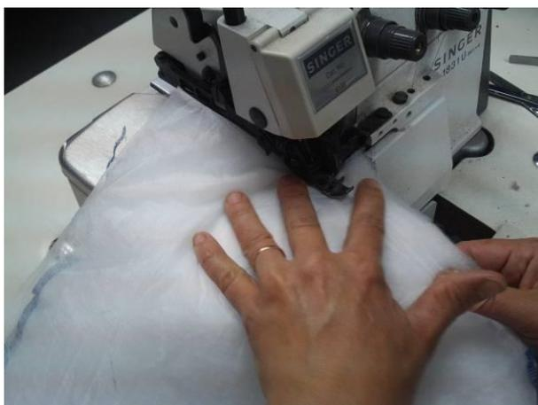
Figura 59 – União por tecnologia convencional da estrutura multicamada
