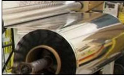
Figura 27 – Substratos metalizados com alumínio por vácuo
