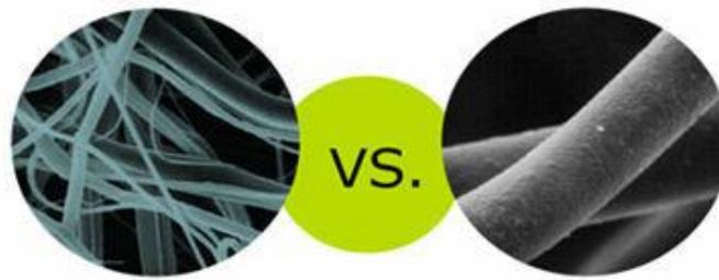
Figura 10– Fibras de Thinsulate™ vs Fibras sintéticas tradicionais (3M 2012).
