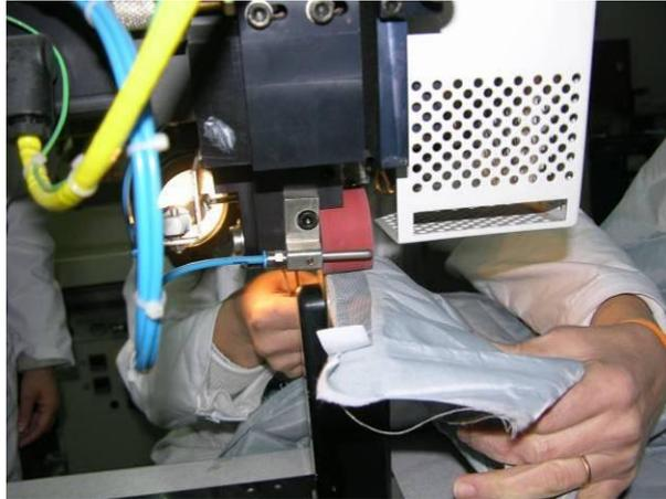
Figura 42 - Aplicação de fita termo-adesiva para acabamento do blusão após incorporação do aerogel
