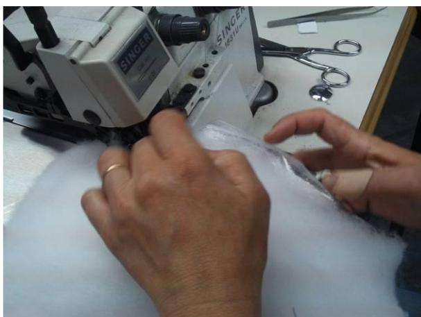
Figura 58 – União por tecnologia convencional da estrutura multicamada
