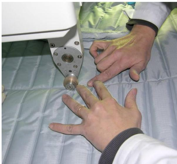
Figura 37 - União dos componentes do blusão por ultrassons após incorporação do aerogel
