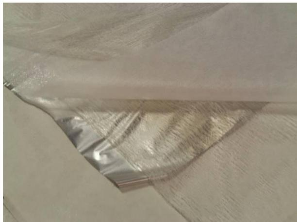
Figura 51 - Membrana metalizada, adesivo co-Poliéster em forma de rede e não tecido compacto 100% poliéster
