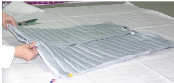
Figura 35 - Pré-montagem do blusão para incorporação do aerogel
