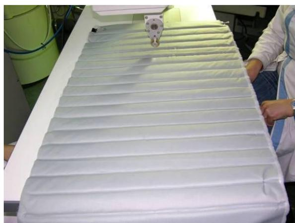
Figura 33 - Construção de componentes do blusão por tecnologia ultrassons
