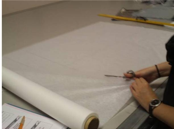
Figura 49 - Adesivo co-poliéster em forma de rede - 8g/m<sup>2</sup> (AB-TEC)
