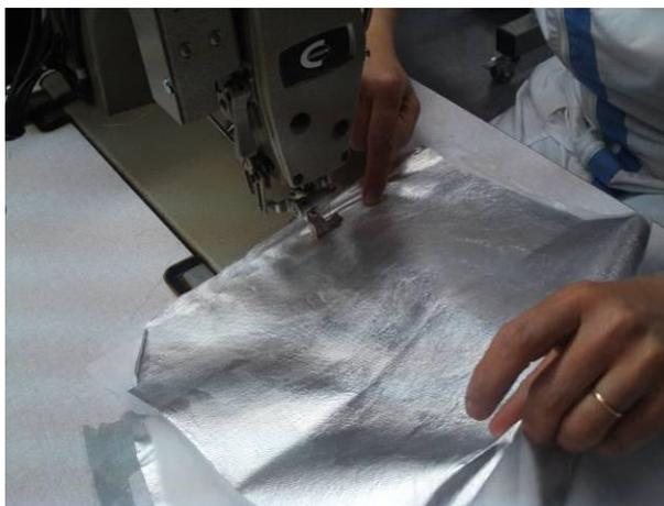
Figura 56 – Costuras convencionais na membrana metalizada (laminada com não-tecido compacto)
