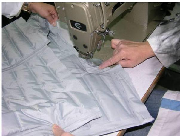
Figura 38 - União dos componentes do blusão com costuras convencionais após incorporação do aerogel
