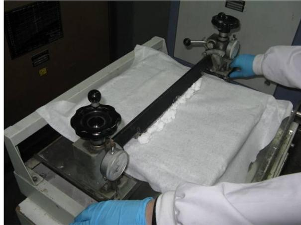
Figura 60 - Revestimento do não tecido compacto (3ª e 7ª camada) com aerogel
