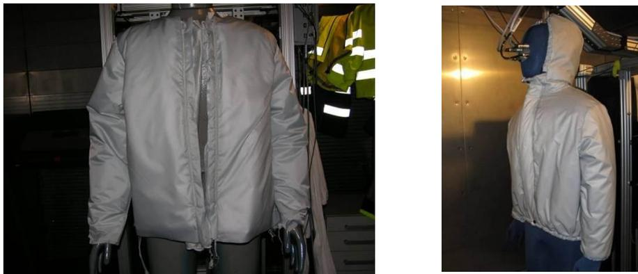
Figura 74 – 2º protótipo do blusão de elevado isolamento térmico
