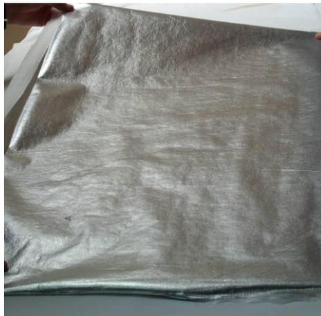
Figura 54 – Membrana metalizada laminada com não-tecido compacto
