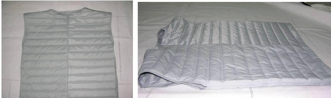
Figura 72 – 1º Protótipo do blusão com incorporação do aerogel
