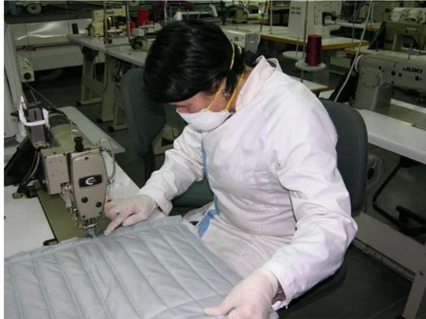
Figura 39 - União dos componentes do blusão com costuras convencionais após incorporação do aerogel
