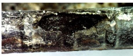
Figura 3.19 – Corrosão localizada (Jaggi *et al.*, 2001)
