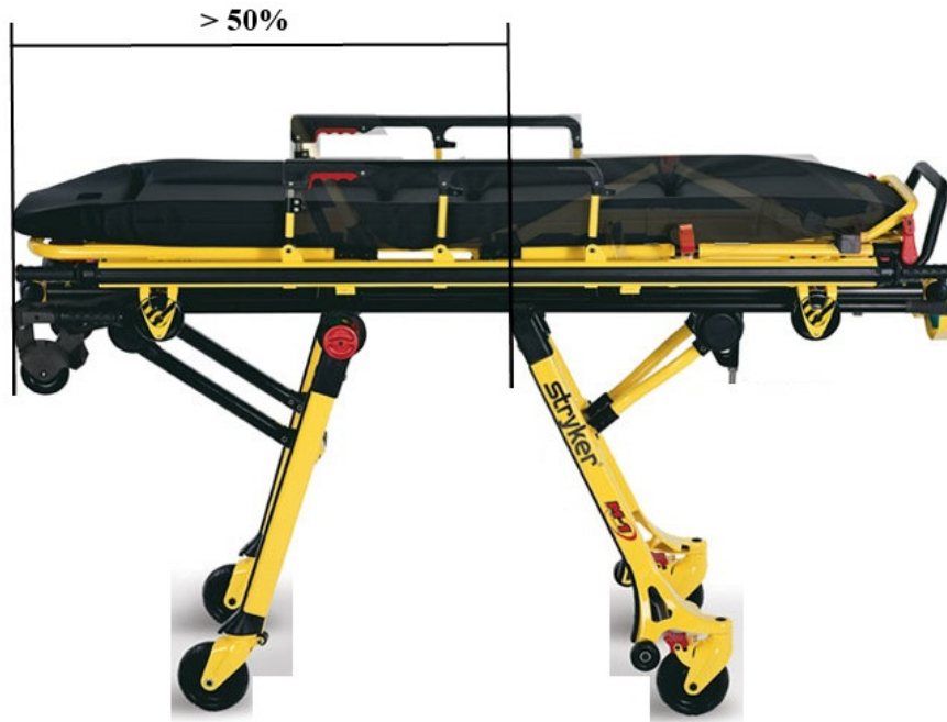
Fig.4.3 - Princípio de funcionamento da maca Stryker M1
