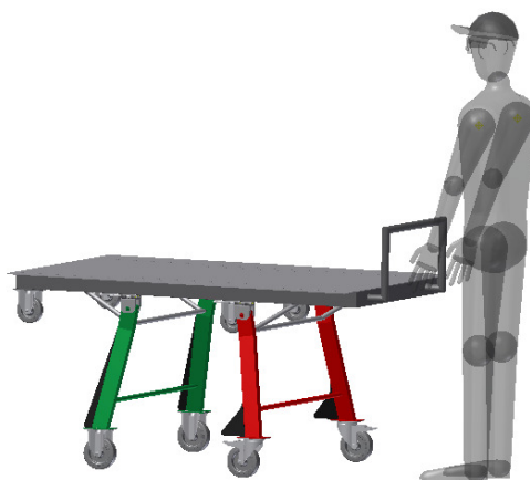
Fig.4.16 - Equipamento com timão ergonomicamente otimizado
