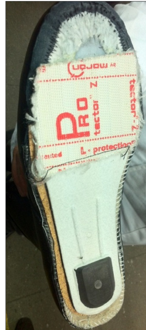
Figura 20 – Inserção anti penetração colada na palmilha de montagem
