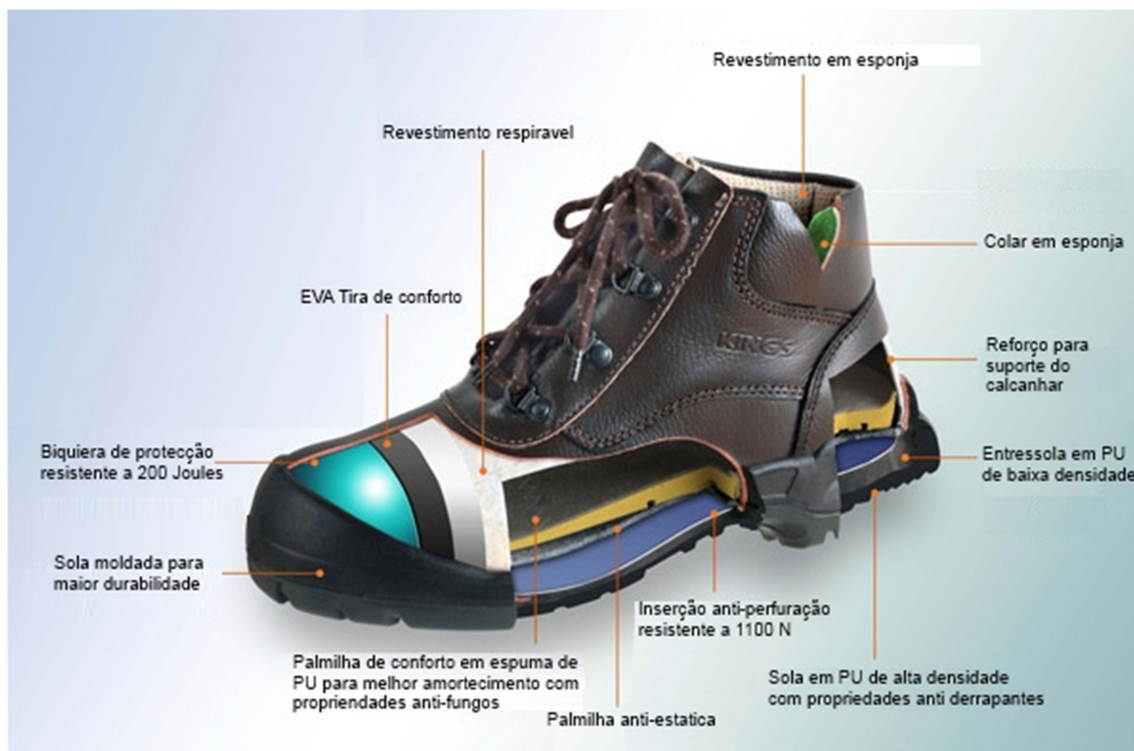
Figura 4 – Componentes constituintes de um sapato de segurança adaptado de [7]
