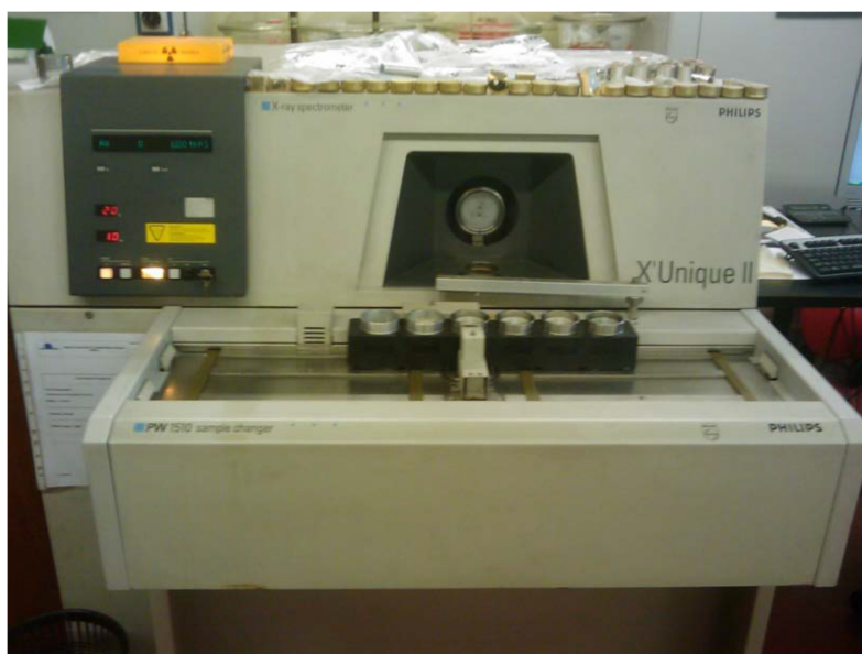
Figura 57 – Espectrómetro Philips X'Unique II X-Ray
