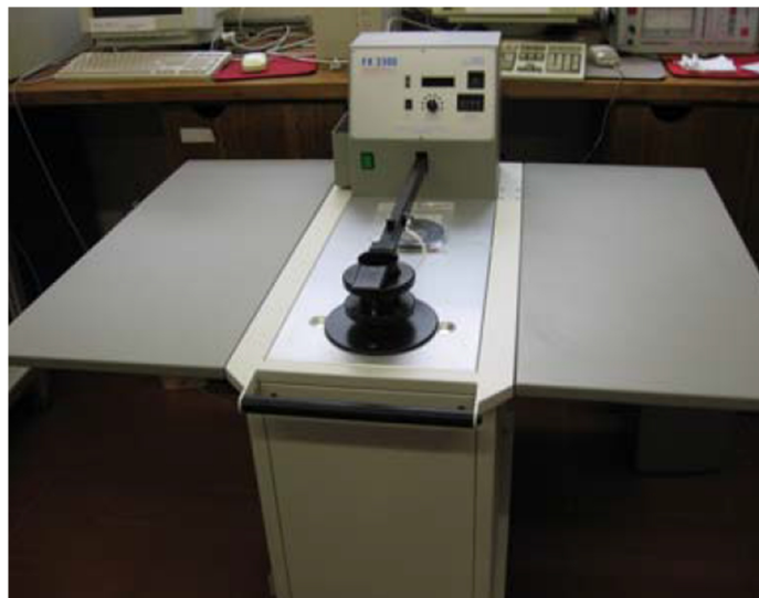
Figura 60 – Equipamento Voronoi-Delaunay meshing scheme usado para a medição da permeabilidade ao ar dos spacers.
