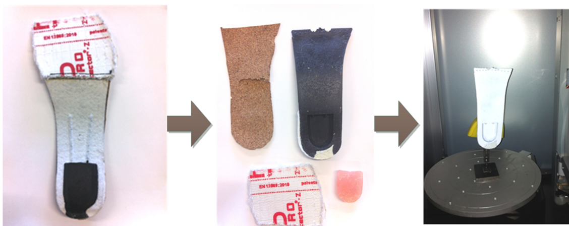
Figura 30 – Pré tratamento da inserção anti penetração composta
