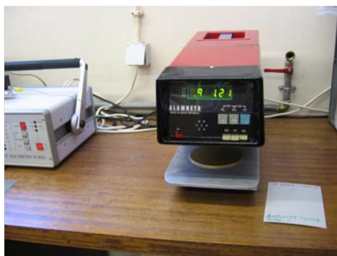
Figura 62 – Alambeta usado para a medição da espessura e propriedades térmicas dos spacers
