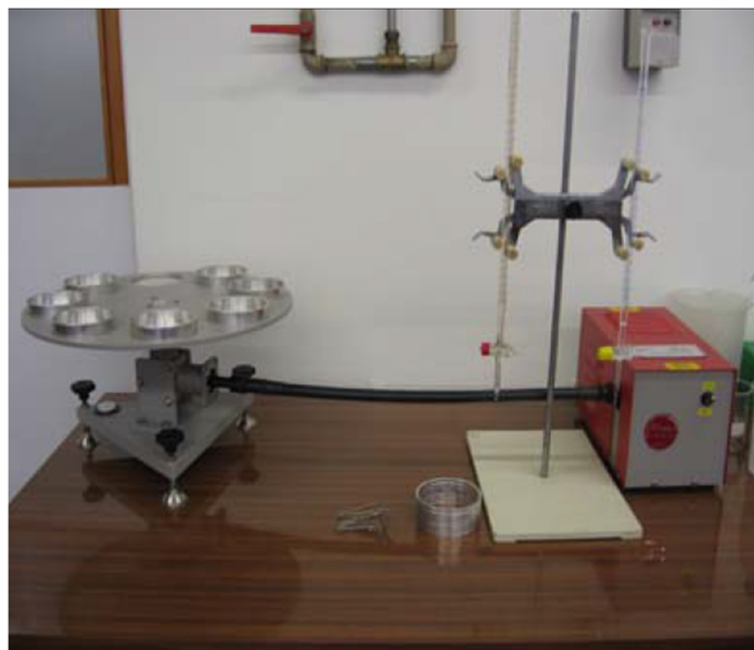
Figura 61 – Equipamento usado para a medição da permeabilidade ao vapor de água dos spacers
