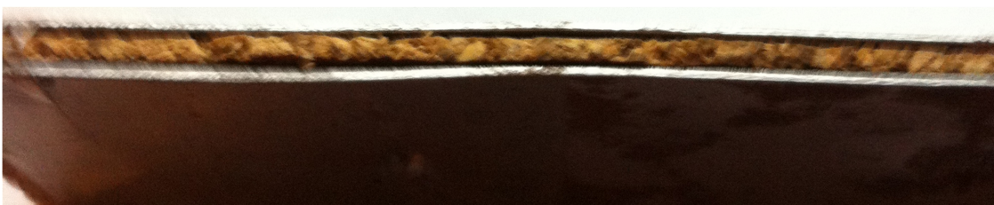
Figura 42 – Sanduiche de cortiça testada à penetração
