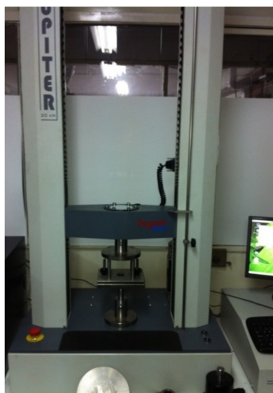
Figura 35 – Equipamento utilizado nos testes à penetração das amostras de inserções anti penetração
