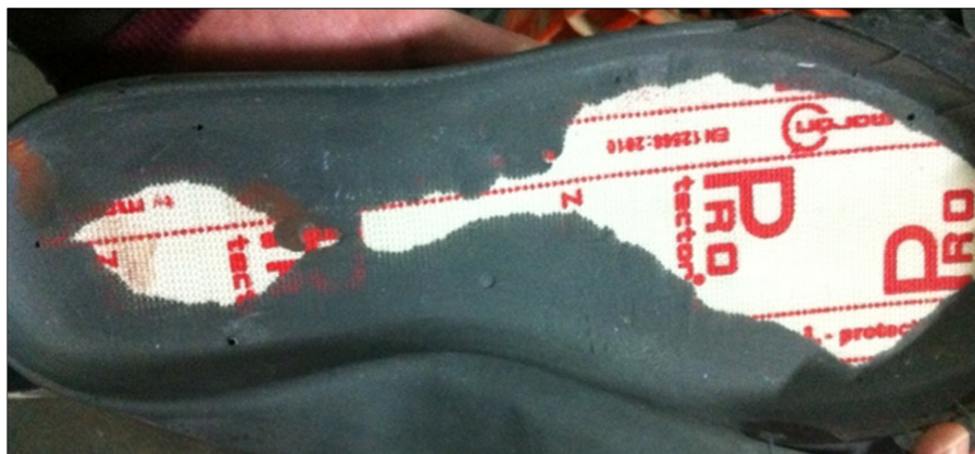
Figura 21 – Inserção anti penetração inserida na sola do sapato
