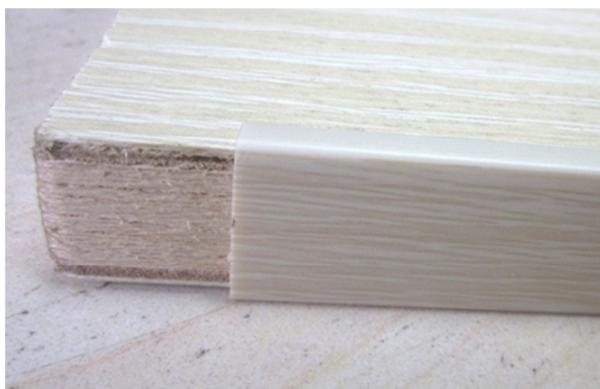
**Figura 21 – Representação do processo de orlagem de superfícies**
