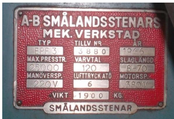
**Figura 23- Especificações Técnicas da prensa existente**
