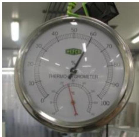
**Figura 108** - Termo higrómetro com as condições de temperatura e humidade relativa no túnel
