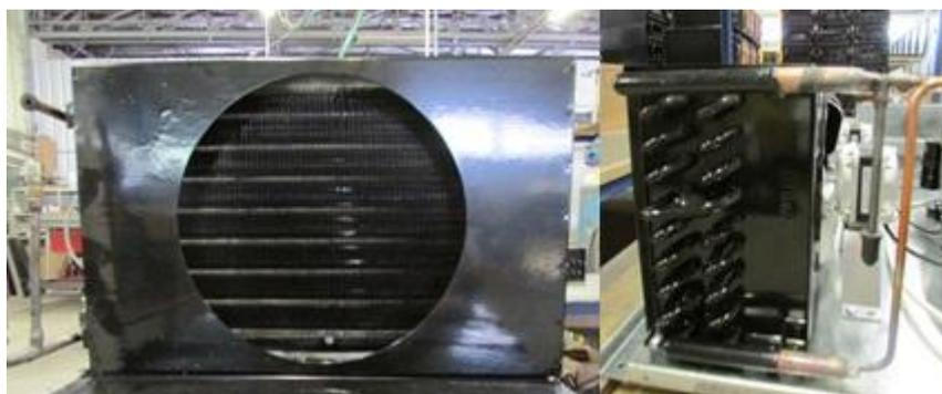
Figura 29 - Exemplo de um condensador de uma gola
