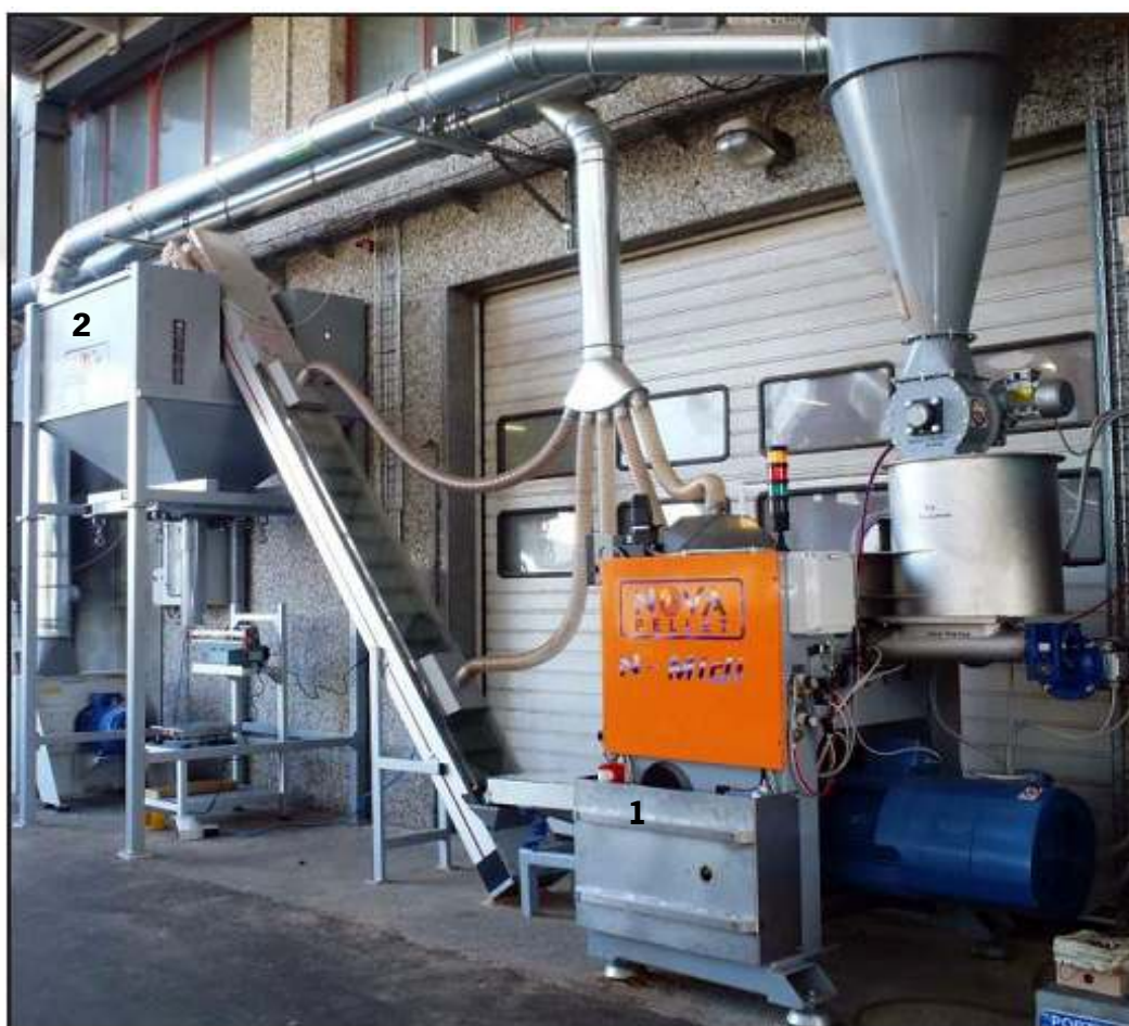
Figura 5.1: Linha de produção de pellets: 1) sistema de peletização; 2) sistema de embalagem
