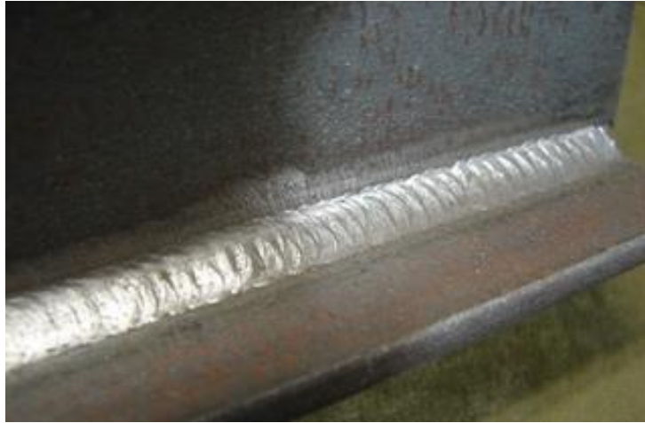
Figura 66: Soldadura de ângulo contínua [16]
