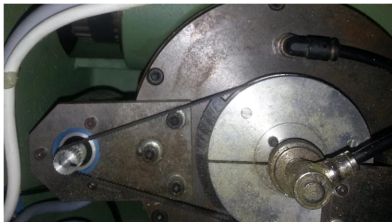
Figura 5.24 Pormenor do interior do eixo B., o encoder ótico é acionado pela correia em destaque
