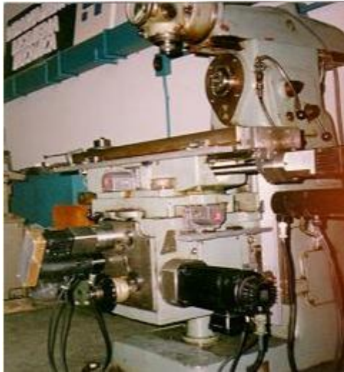
Figura 2.6 Exemplo de aplicação de retrofitting numa fresadora convencional [19]
