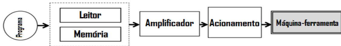
Figura 4.7 Esquema de funcionamento de um sistema de malha aberta [21]
