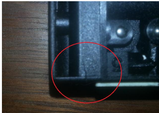
Figura 6.6 Pormenor da fissura registada em várias electroválvulas
