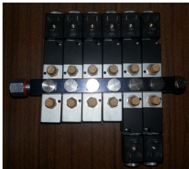
Figura 6.8 Conjunto de electroválvulas Camozzi configuradas para o equipamento em estudo
