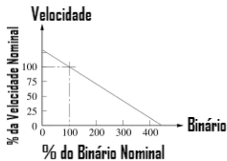
Figura 4. 24 Relação entre a velocidade nominal de um motor elétrico de corrente contínua e o seu binário [41]
