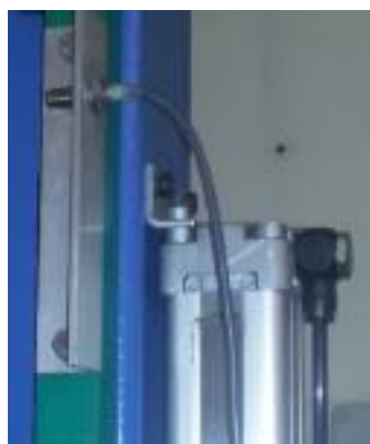
Figura 5.27 Localização dos sensores de fim de curso, “BES-516-324-E4-C-PU-5” no resguardo
