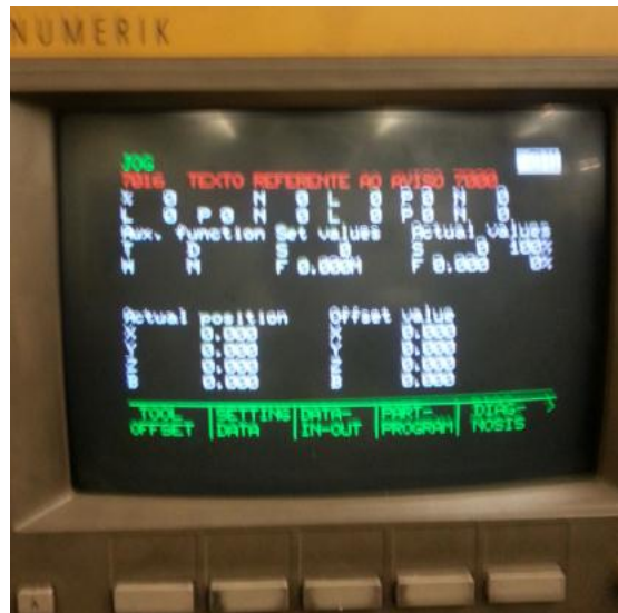
Figura 6.4 Display da máquina-ferramenta em estudo, com informação da posição de cada eixo
