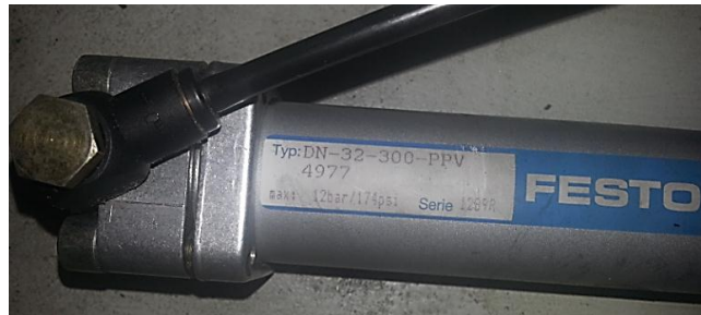
Figura 5.21 Cilindro pneumático de duplo efeito “DN-32-300-PPV-4977” Festo
