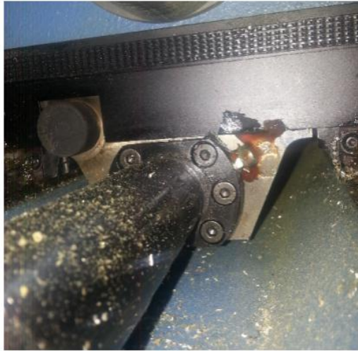
Figura 5.3 Acumulação de resíduos junto ao eixo X
