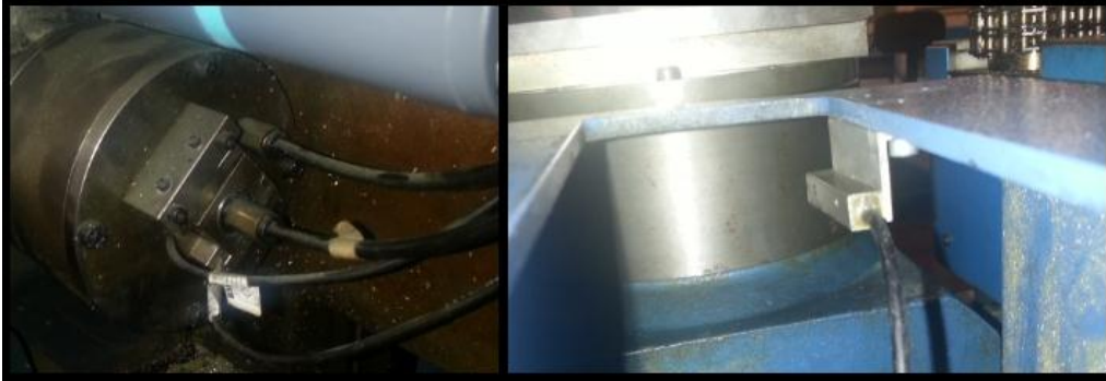
Figura 5.26 Localização dos sensores de fim de curso na verificação da ferramenta de corte, e de posicionamento para o sistema de troca de paleta
