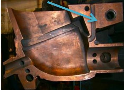
Figura 13 – Canal de Saída de ar e gases.
