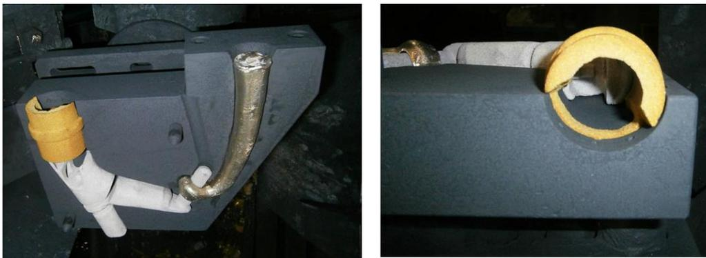
Figura 91 – Representação de simulação de novo sistema de enchimento (Vazamento Lateral).
