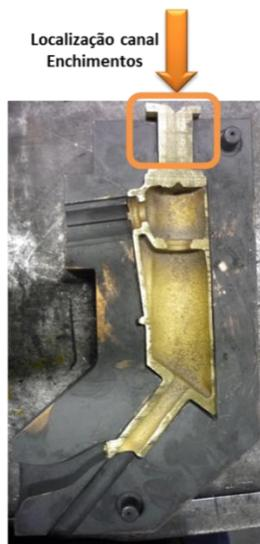
**Figura 75 – Representação de resultados da alteração do posicionamento de giteagem.**
