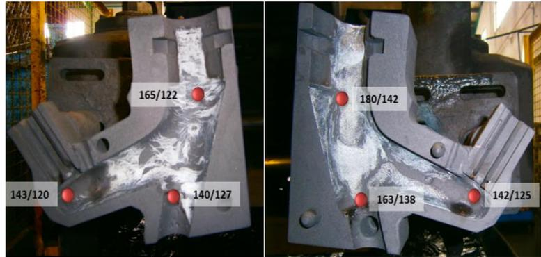
**Figura 103 – Análise térmica da coquilha MB700B, resultantes do teste 3.**
