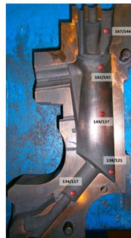
Figura 81 – Análise térmica da coquilha RP740B, resultantes do teste 3.
