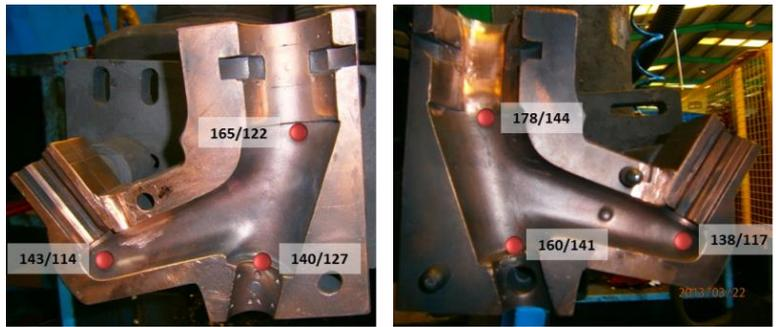
Figura 97 – Análise térmica da coquilha MB700B, resultantes do teste 2.
