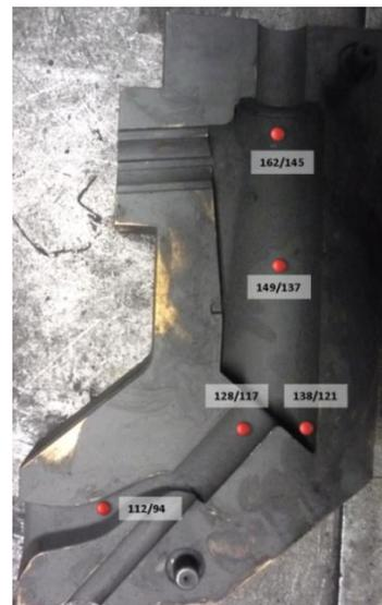
**Figura 76 – Análise térmica da coquilha RP740B, resultantes do teste 2.**
