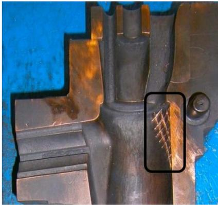
Figura 84 – Representação de malha de nervuras realizada na superfície da coquilha.
