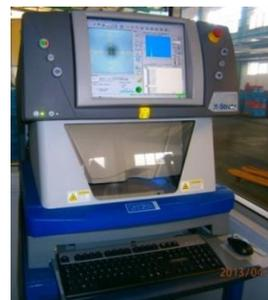
Figura 58 – Representação de Equipamento de análise química OXFORD Instruments X-STRATA.
