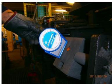
Figura 67 – Representação de Monitorização de inclinação de coquilha para vazamento.
