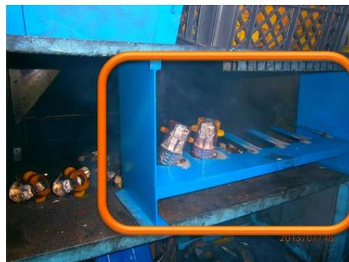
**Figura 53 – Representação placa removível de posicionamento vertical das peças.**
