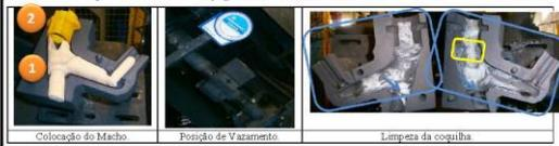
Colocação do Macho      Posição de Vazamento      Limpeza da coquilha
