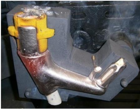
Figura 96 – Representação de peça após abertura de coquilha (Teste 2).
