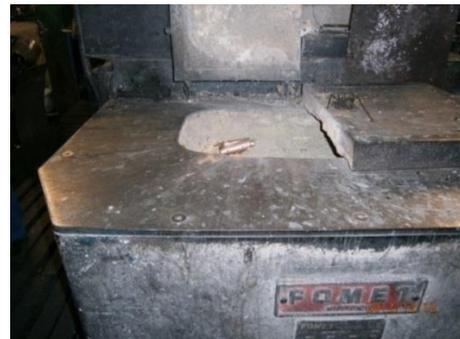
Figura 38 – Representação de camara de carregamento sem sistema de proteção.
