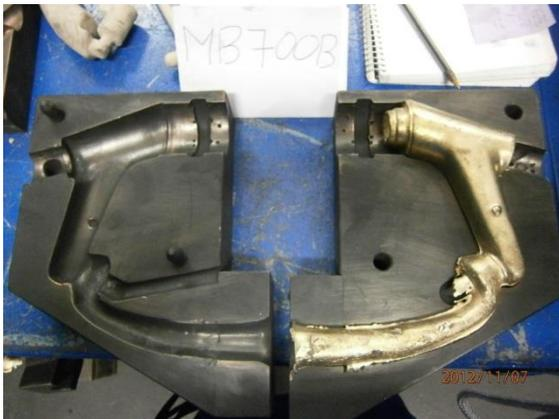
Figura 87 – Representação de coquilha e peça Referência MB700B
