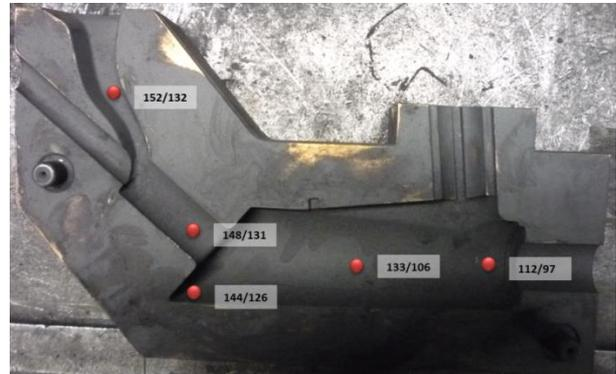
Figura 73 – Análise térmica da coquilha RP740B, resultantes do teste 1.
