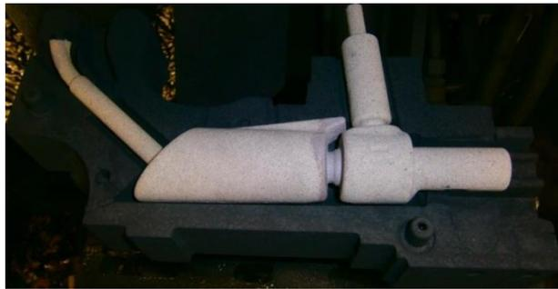
Figura 79 – Modificação da espessura de parede da coquilha.
