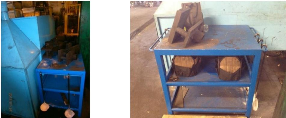
Figura 54 – Representação de estrutura de apoio à troca de ferramentas (Coquilhas e Colheres).
