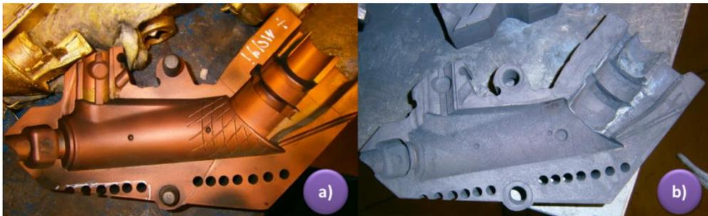
Figura 64 – Representação de coquilha sem cobertura grafite (a), e com cobertura de grafite (b).
