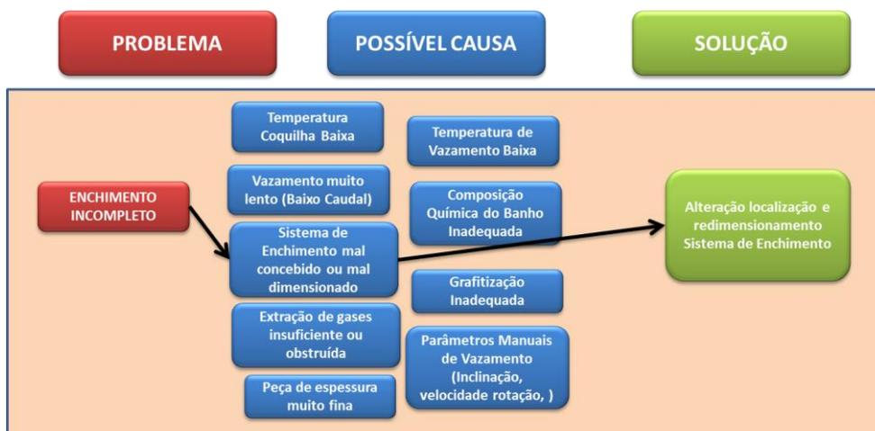
Figura 74 – Esquema de análise causa-efeito resultante do teste1.
