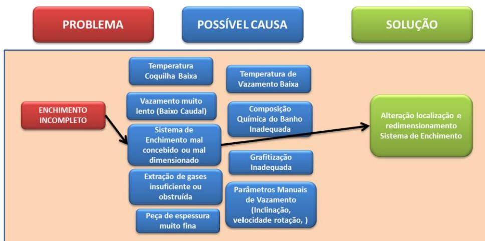
Figura 90 – Esquema de análise causa-efeito resultante do teste1.
