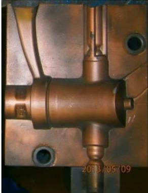
Figura 15 – Representação de coquilha com Espessura de parede da peça não uniforme.
