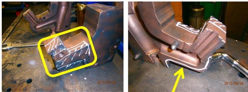
Figura 100 – Representação de redução de matéria da coquilha teste 3.
