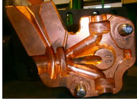
Figura 16 – Representação de coquilha com Espessura de parede da peça uniforme.
