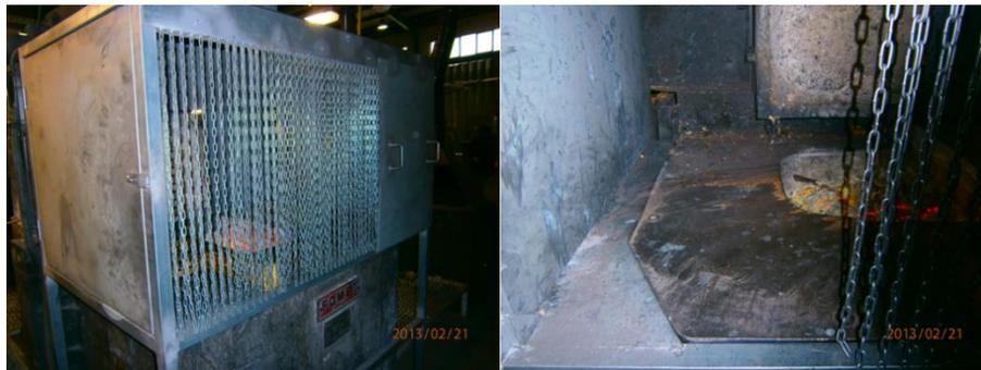
Figura 48 – Representação da estrutura metálica de proteção da camara de carregamento do forno.
