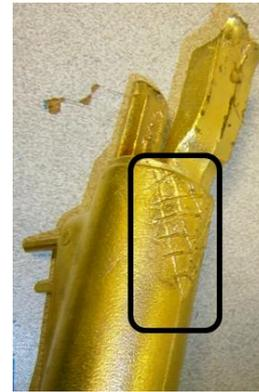
Figura 85 – Representação de malha de nervuras resultante na peça.
