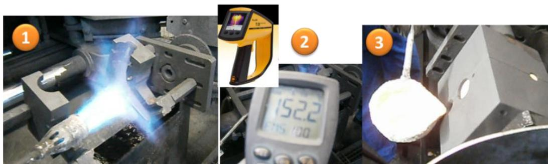
**Figura 68 – Representação de controlo térmico da coquilha para validação de iniciação de produção.**
