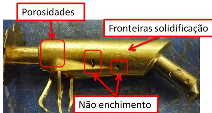
Figura 77 – Peça obtida no teste 2.
