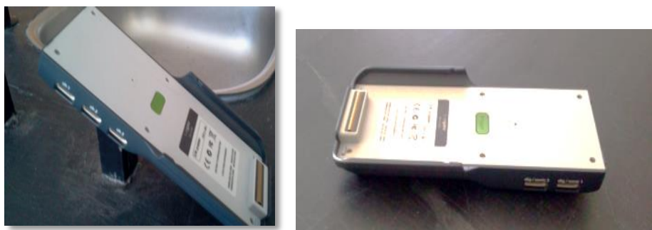
Figura 2.5 – Fotografias do Lab Cradle mostrando as três entradas analógicas (esquerda) e as duas digitais (direita)
