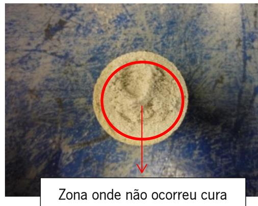
**Figura 11 - Espessura de cura do macho**
