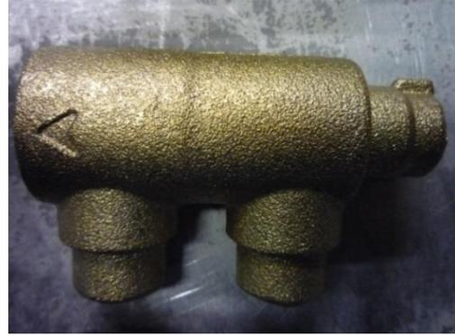
**Figura 41 - Exemplo de peça bem grenalhada**
