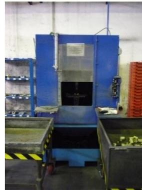
**Figura 28 - Máquina vibratória**
