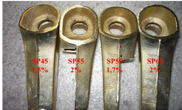
**Figura 64 - Resultados obtidos com a alteração da granulometria da areia**
