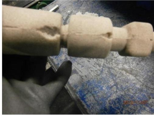
**Figura 12 - Defeito causado por mau fecho da caixa**
