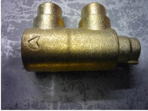
**Figura 40 - Exemplo de peça mal grenalhada**
