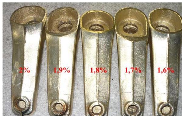
**Figura 44 - Resultados obtidos com a alteração da percentagem de resina**
