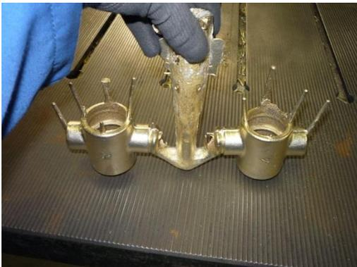
**Figura 45 - Referência RP749B (peça com gitos)**
