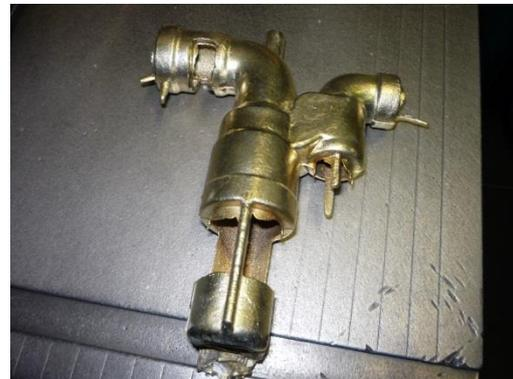
**Figura 46 - Referência RPE761B (peça com gitos)**
