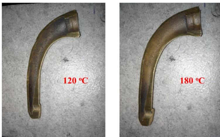
**Figura 67 - Variação do aspecto interior do fundido com o aumento da temperatura de cura do macho**
