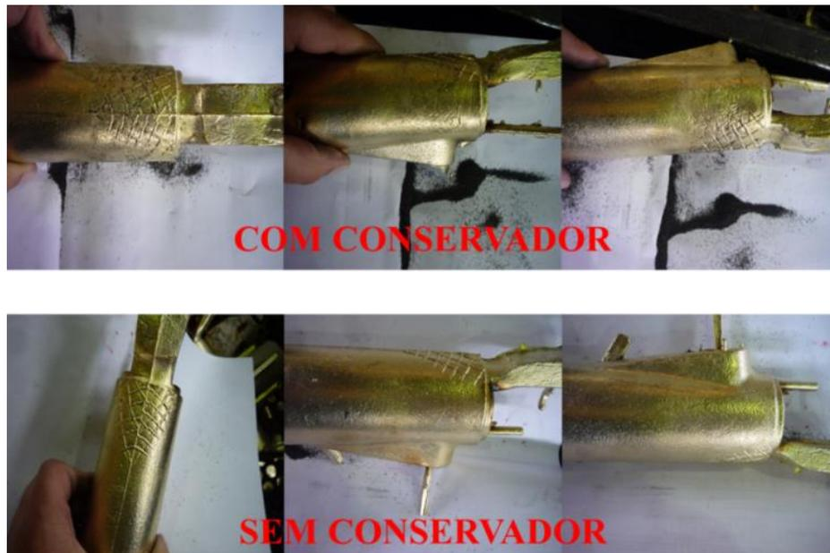
**Figura 65 - Exemplo de peça obtida com a utilização de machos com e sem conservador**
