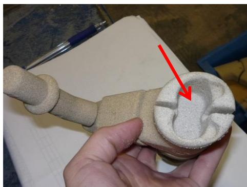
**Figura 10 - Pormenor do macho gerado pelos extractores verticais**
